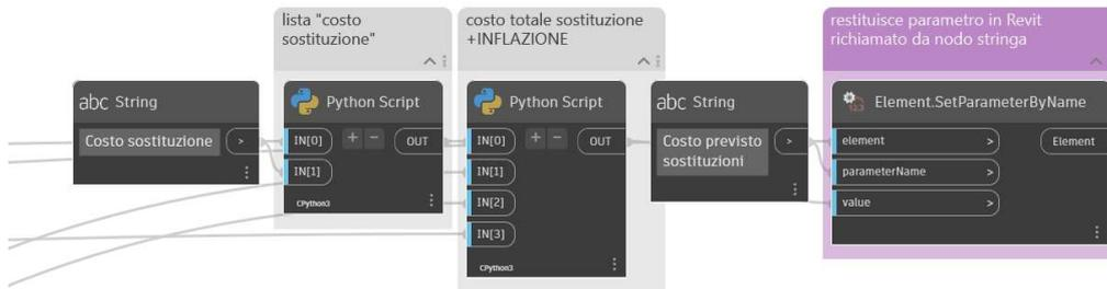
Figura 76: Parte 6 del codice a nodi (previsione costi) in ambiente Dynamo.
