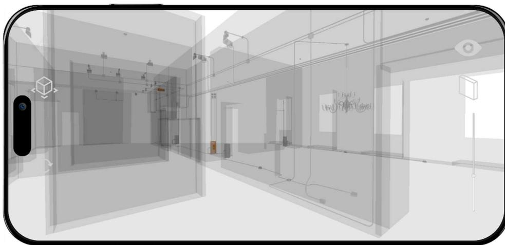
**Figura 89:** Schermata applicativo AR, visualizzazione del modello architettonico in trasparenza gestita dallo slider.
