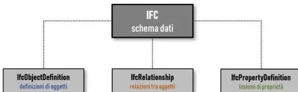
**Figura 5:** Diagramma composizione schema dati IFC<sup>8</sup>
