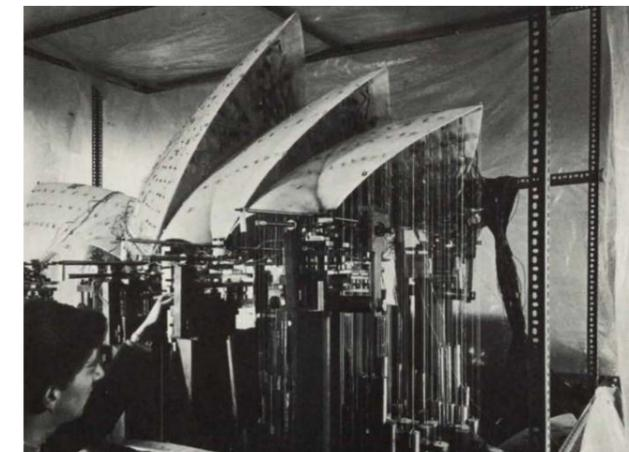
► "Test strutturale su modello in scala", HOGGETT P., (a cura di), 1973, p. 10.
