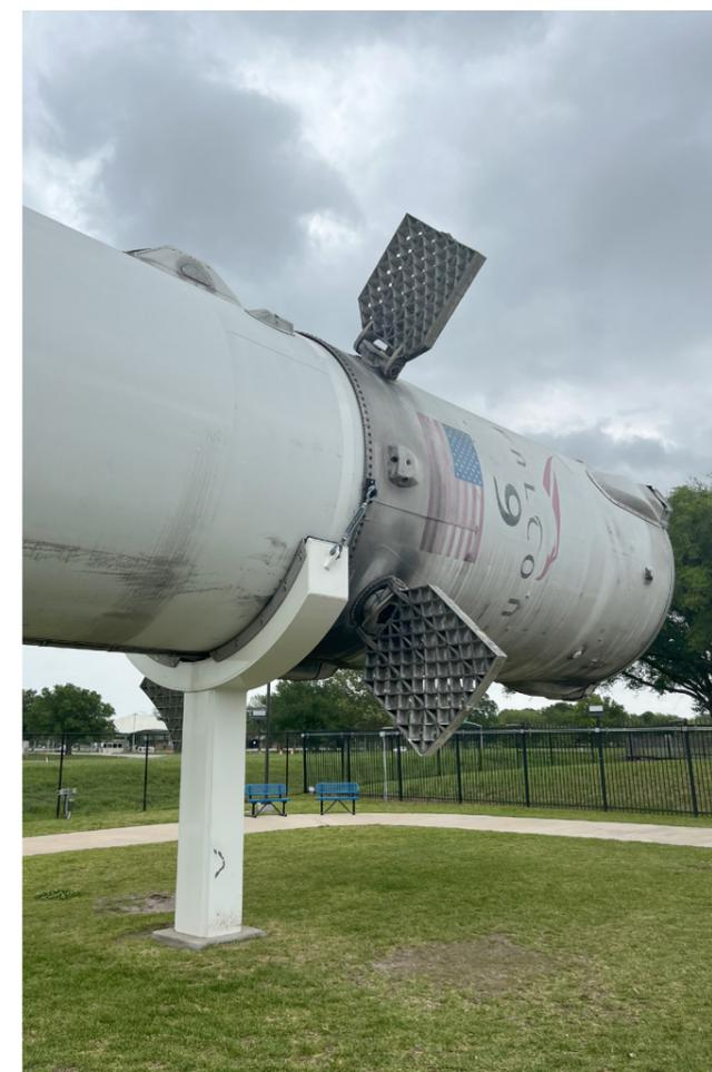
► "Falcon 9". Composizione (a destra), e fotografia delle alette che ne permettono la stabilizzazione (fotografia scattata dall'autore, in alto). SPACE X, 2021.
