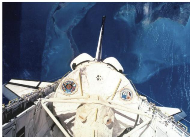
► "Spacelab nel vano cargo della navetta spaziale Columbia, missione STS-9, novembre 1983, lanciato dalla NASA e dall'ESRO, è il primo laboratorio scientifico installato sullo Space Shuttle, ospita fino a quattro astronauti per condurre esperimenti in orbita. La costruzione coinvolge aziende di dieci Paesi europei, con la Germania capofila del programma e l'Italia seconda con il 18%".
