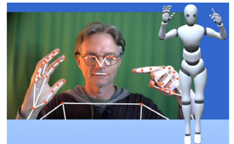
fig.21a Mocap tramite DollarsMocap. Questo software gratuito crea in tempo reale un'armatura da associare all'utente che si muove senza bisogno di sensori, per registrare il movimento di alcuni punti chiave e poi trasferirlo su un'armatura 3D associata.
