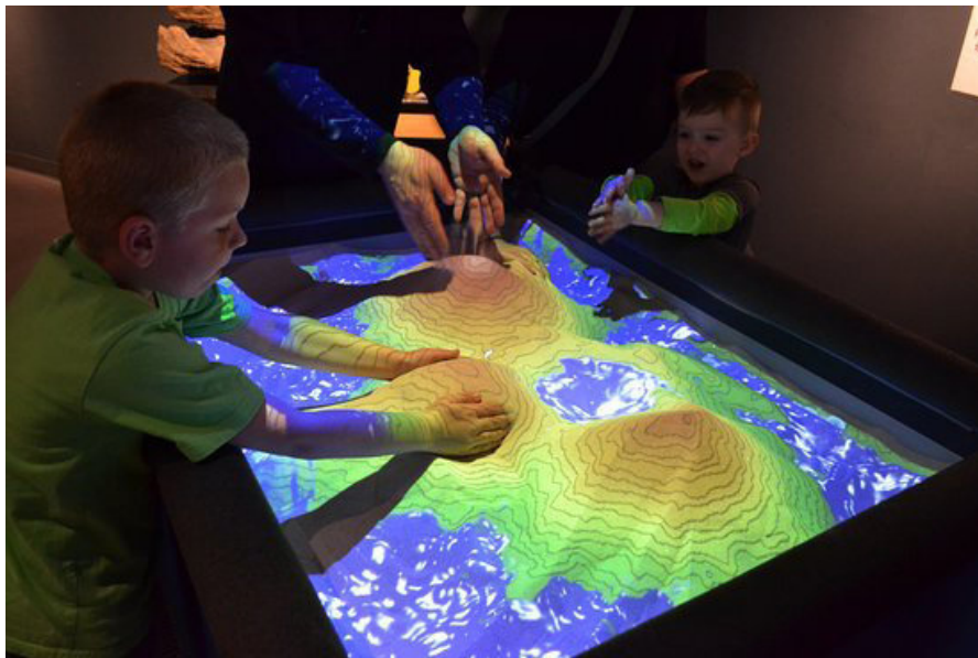
Figura 1.4. Sistema realtà aumentata basato su proiettore
