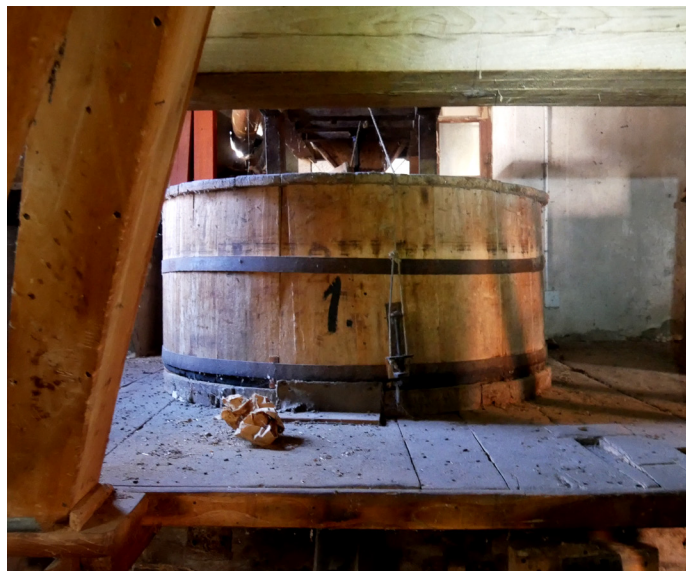
Figura 4.1.2- Fotografie di due delle tre macine del mulino di Monterosso, a destra il palmento per la segala, a sinistra quello per il grano.
