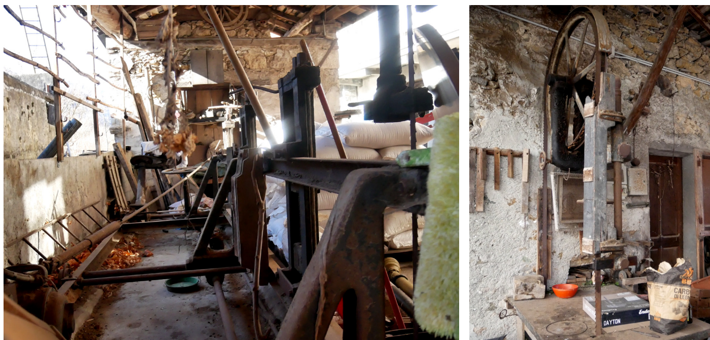
Figura 4.1.1- Fotografie della segheria di Monterosso, a sinistra carrello della segheria, a destra una sega da traforo
