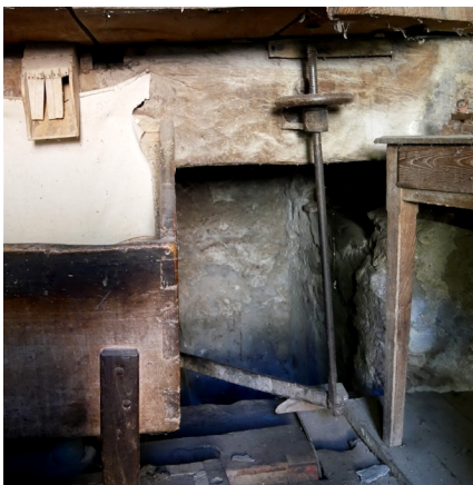
Figura 1.9- Meccanismo a vite per la regolazione della distanza tra le pietre di macina
