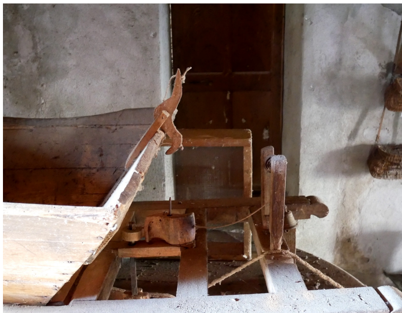
Figura 4.1.3-Fotografia del mulino di Monterosso Grana, Uccello di legno con campanellino.
