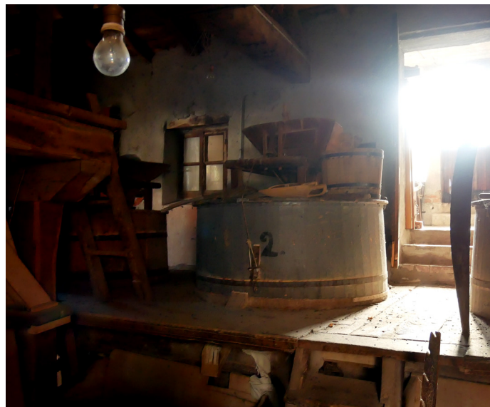
Figura 4.1.2- Fotografie di due delle tre macine del mulino di Monterosso, a destra il palmento per la segala, a sinistra quello per il grano.
