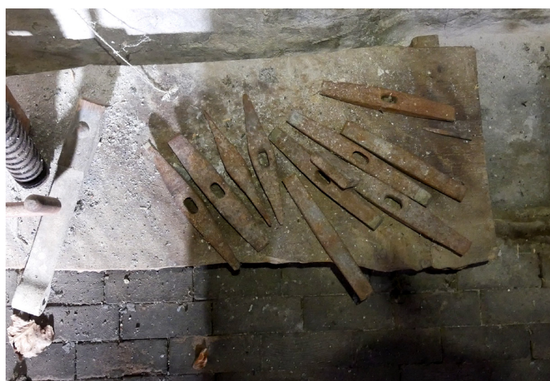
Figura 4.1.4-Fotografia del mulino di Monterosso Grana, teste di martelli per la martellatura delle pietre di macina, a seconda dello scopo della pietra erano diversi.
