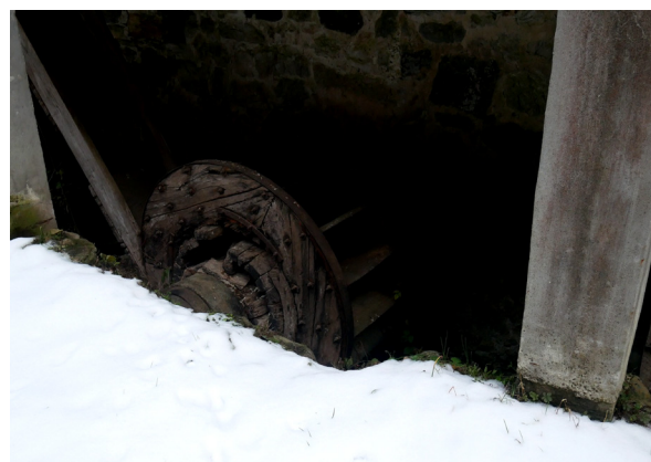
Figura 4.4.1- Fotografie delle due ruote del mulino di Pradlevés, a destra (a) la più grande che alimentava le macchine, a sinistra (b) la più piccola per l'alimentazione del maglio.
