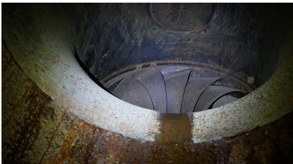
Figura 4.2.2- Fotografia della turbina Francis Installata nel mulino Monterosso Grana.
