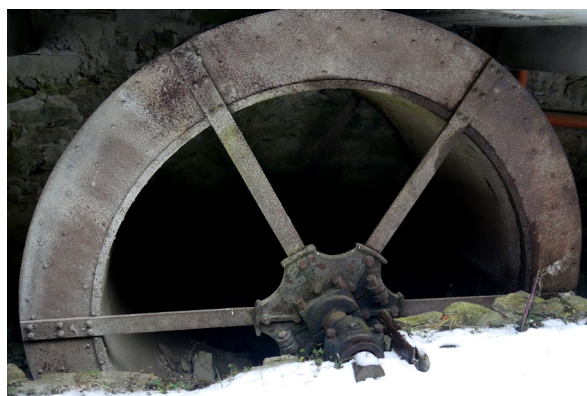
Figura 4.4.1- Fotografie delle due ruote del mulino di Pradlevés, a destra (a) la più grande che alimentava le macchine, a sinistra (b) la più piccola per l'alimentazione del maglio.
