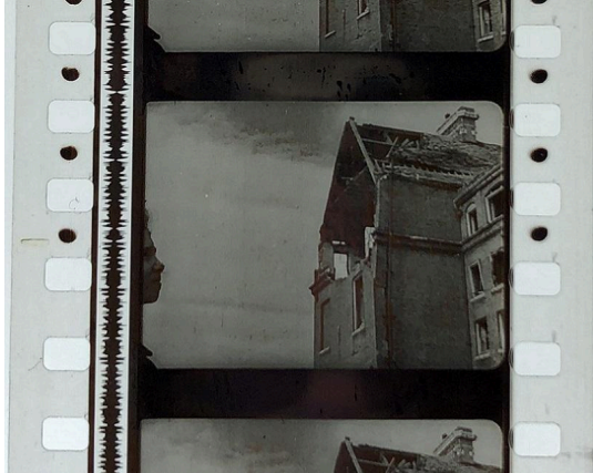
Figura 1.2: pista ottica monofonica ad area variabile.
