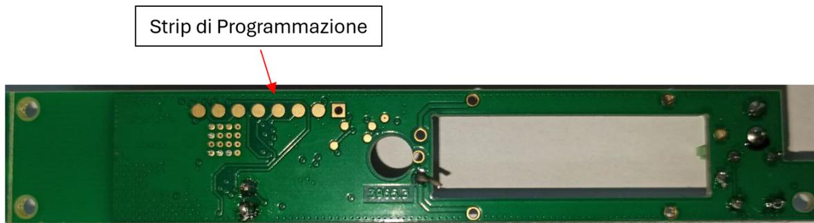
Figura 4: Retro del circuito del contatto 3V linea 868 da interno.
