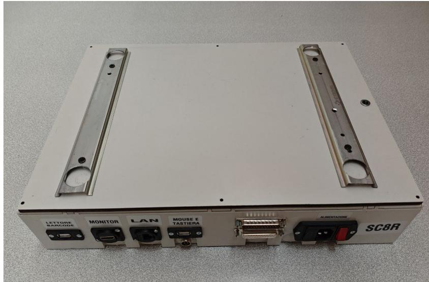
Figura 52: Contenitore plastico con elettronica.
