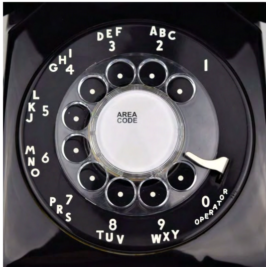
Figura 37: I caratteri alfanumerici spostati all'esterno del disco combinatore, sostituiti dai punti di mira, nel Modello 500, Henry Dreyfuss 1949 [79].
