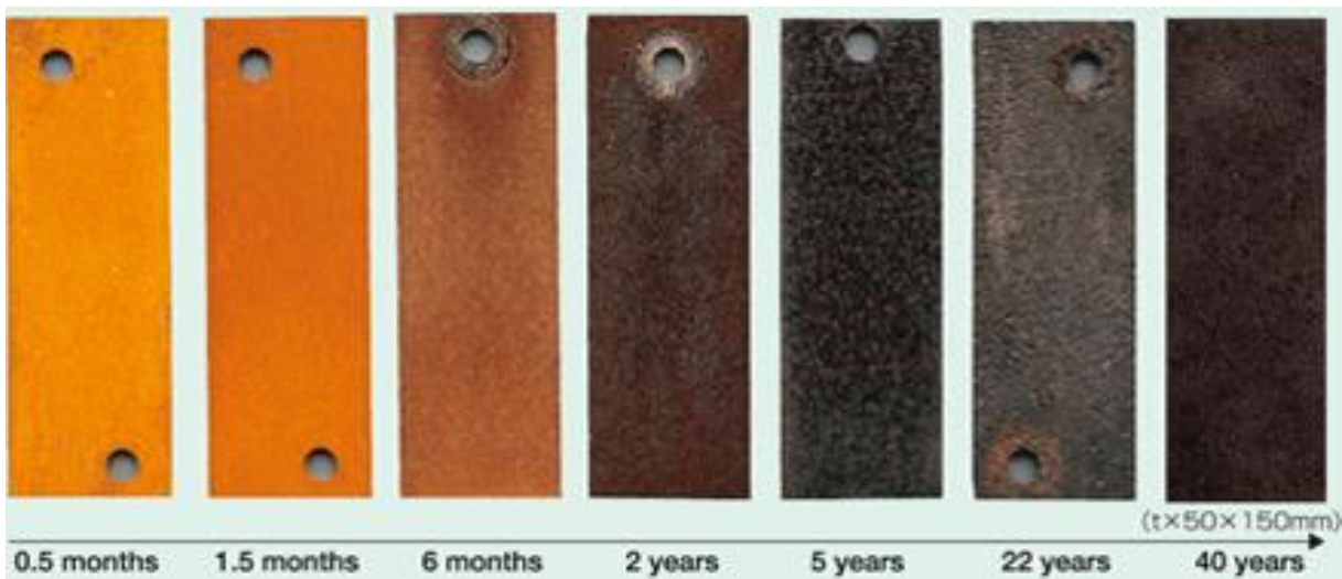
Fig 1) Invecchiamento di una lastra in corten nel corso del tempo. Immagine da www.nipponsteel.com
