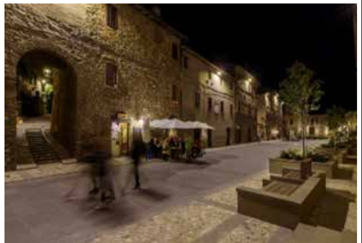
Illuminazione degli edifici con apparecchi a parete sotto gronda
