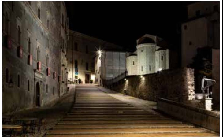
La scalinata e l'abside della Chiesa di Santa Eufemia, illuminazione è di temperature di colore differenti per valorizzare i materiali delle singole architetture
