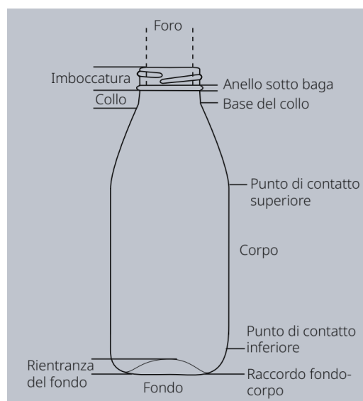
Figura 9: Parti di un contenitore in vetro. Fonte: Difetti dei contenitori di vetro Cause e rimedi [7]
