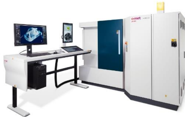
Figura 28: tomografo per metrologia industriale: Fonte: Xrayconsult [71]
