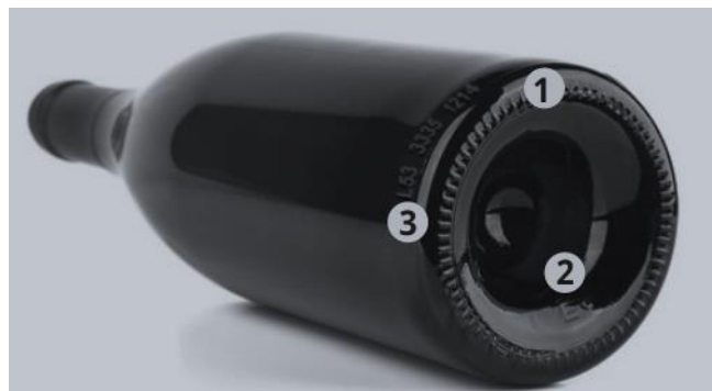
Figura 10: raccordo fondo-corpo e fondo di un contenitore in vetro. Fonte: Difetti dei contenitori di vetro Cause e rimedi [7]
