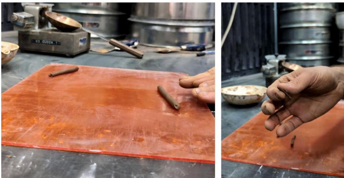
Figura 6.11: Realizzazione bastoncini per la determinazione del limite plastico
