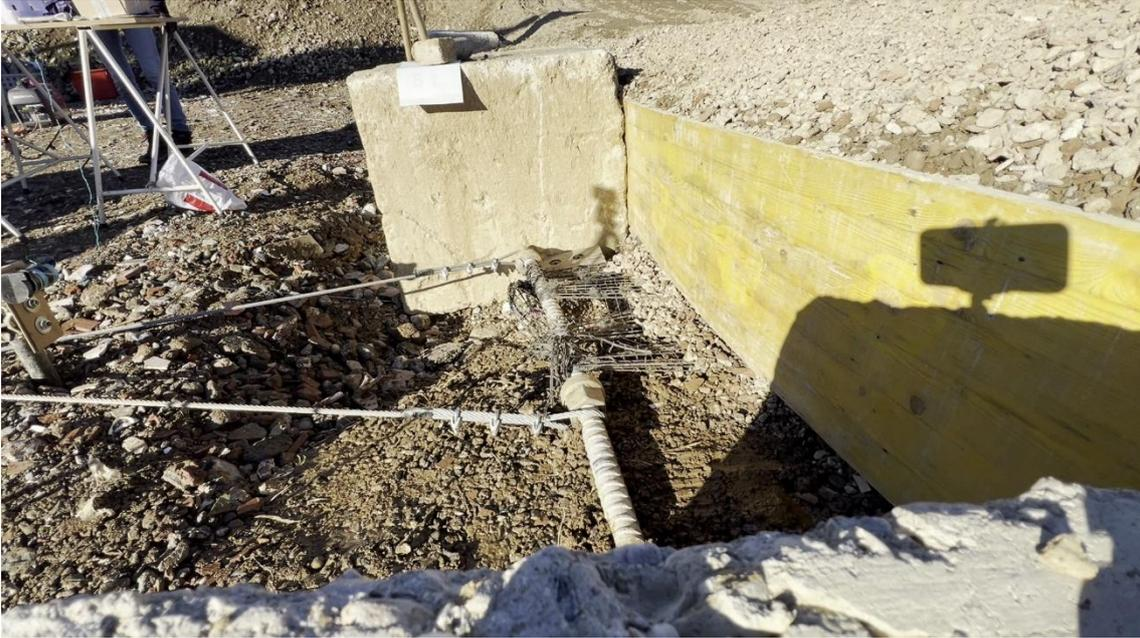
*Figura 6.26: Prova di sfilamento B1; Lo sfilamento della geogriglia è maggiore rispetto all'istante fotografato precedentemente. Si notano ora facilmente gli aggregati costituenti il rilevato fuoriuscire sopra il rinforzo.*
