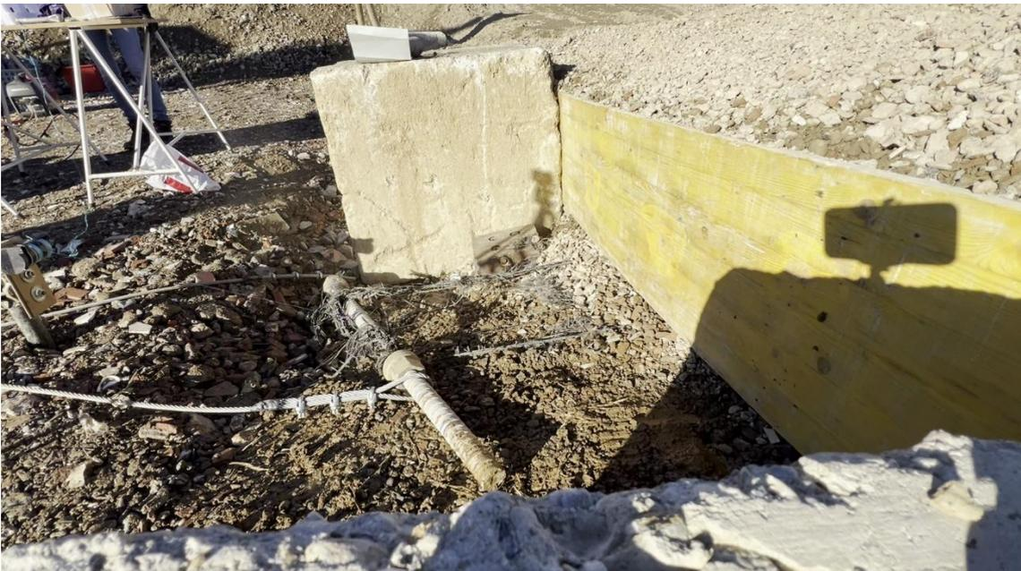
*Figura 6.27: Prova di sfilamento B1; Rottura per strappo dei filamenti longitudinali della geogriglia*
