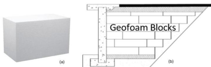
*Figura 1.9: Dettaglio del Geofoam (a) e illustrazione di un possibile utilizzo (b).*
