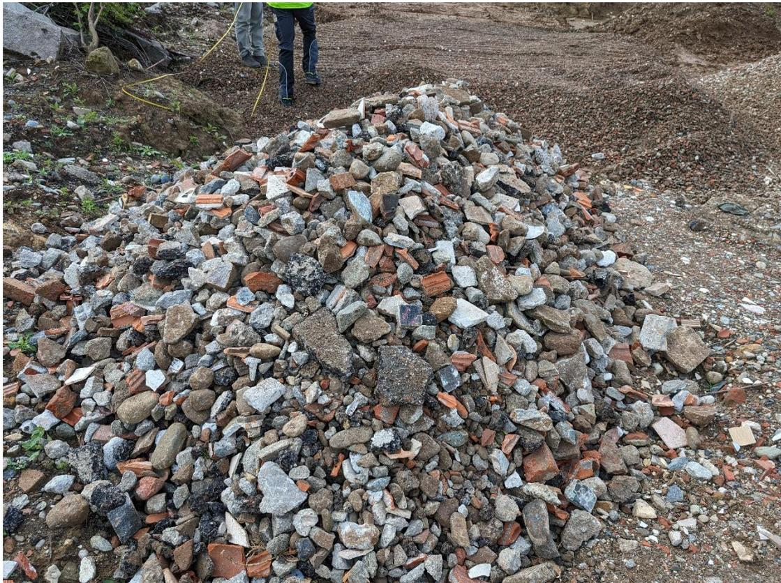
*Figura 6.2: Aggregato 0-80 millimetri in mucchio.*
