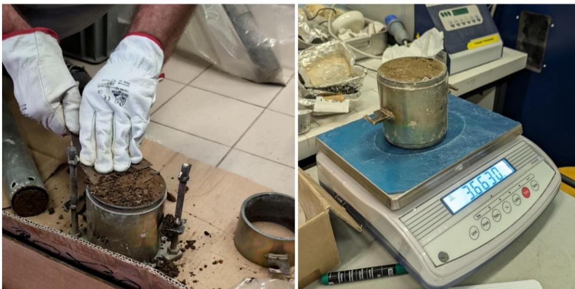
*Figura 6.7: Rimozione del collare e livellazione del terreno in sommità a sinistra. Pesatura del campione costipato a destra.*
