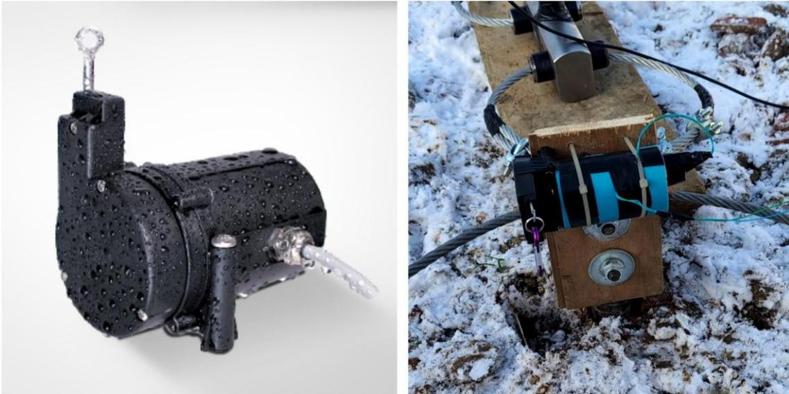
Figura 6.19: Trasduttore per misurare lo spostamento
