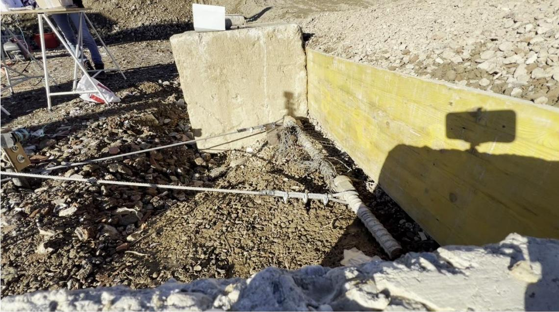
*Figura 6.24: Prova di sfilamento B1; La foto mostra l'istante prima dell'inizio dell'applicazione della forza*
