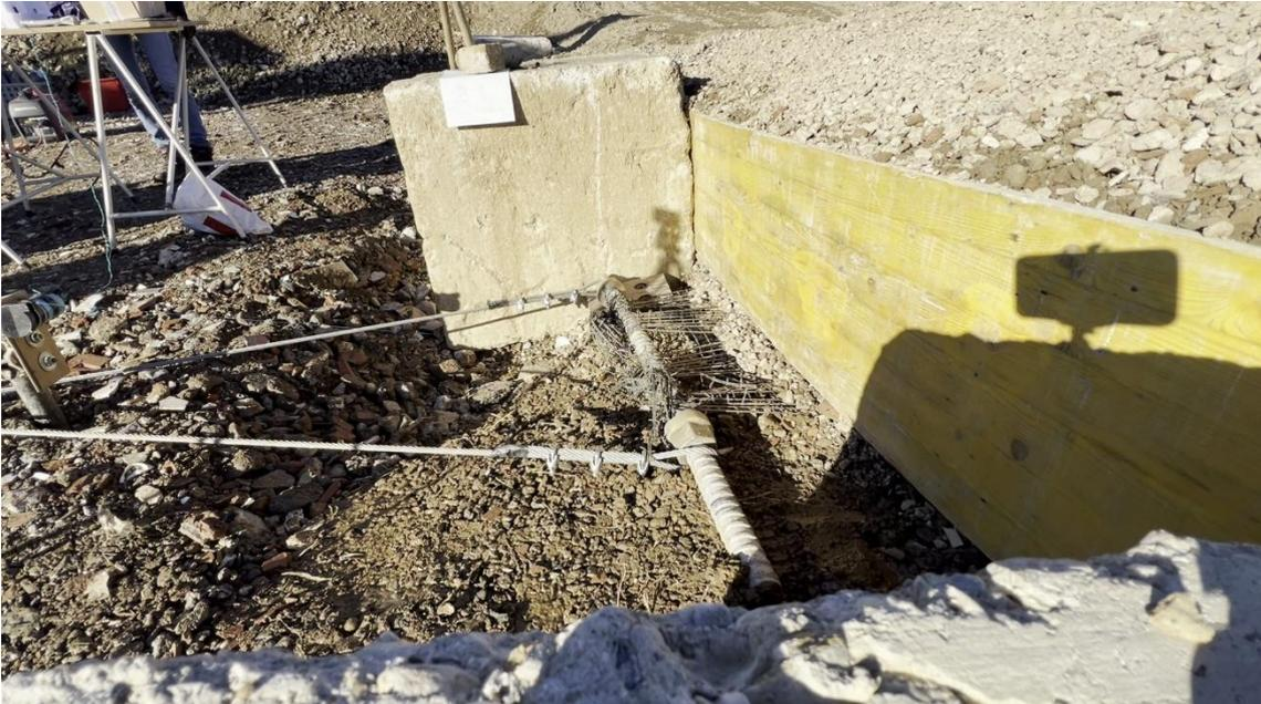
*Figura 6.25: Prova di sfilamento B1; Si nota lo spostamento della barra e della geogriglia, a causa del parziale sfilamento della seconda*
