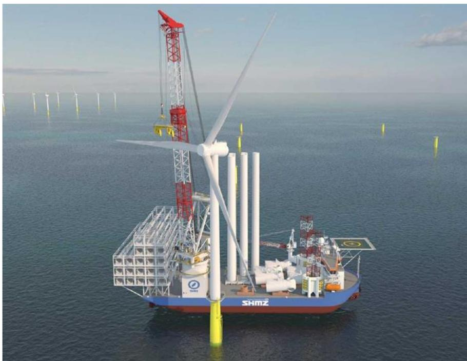
Figura 3.11: Imbarcazione di tipo *purpose-built jackup vessel* (rendering) (4C Offshore)
