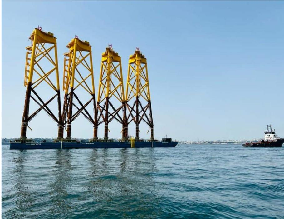
Figura 3.10: Chiatta per il trasporto delle fondazioni jacket (Ailes Marines, 2022)
