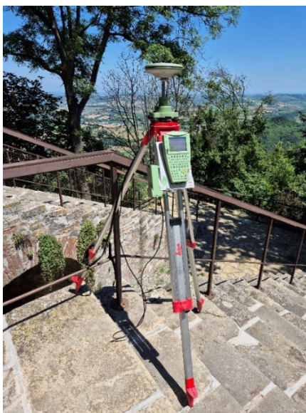
Figura 68: Messa in stazione del ricevitore GPS/GNSS.
