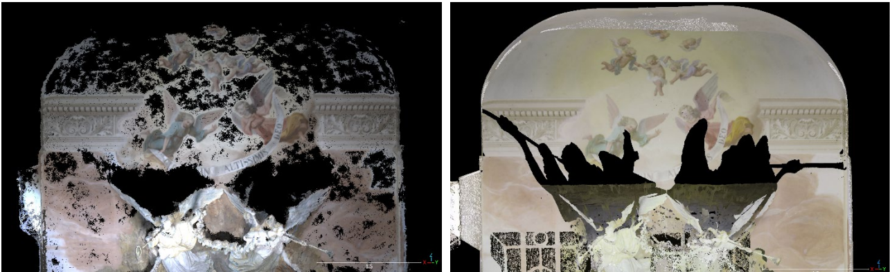
Figura 165: Confronto tra sezione volta Cappella 10 nella nuvola da Stonex XVS (sinistra) e Leica RTC 360 (destra).
