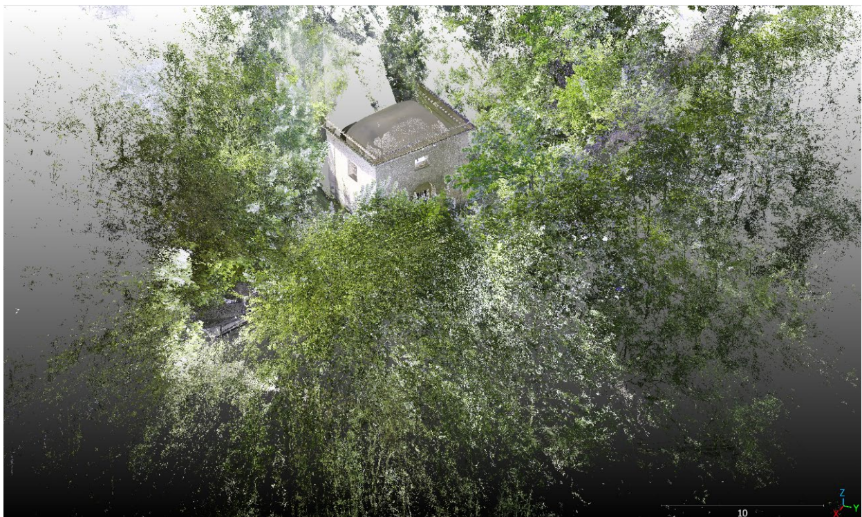
Figura 108: Nuvola di punti della Cappella 10 grezza.
