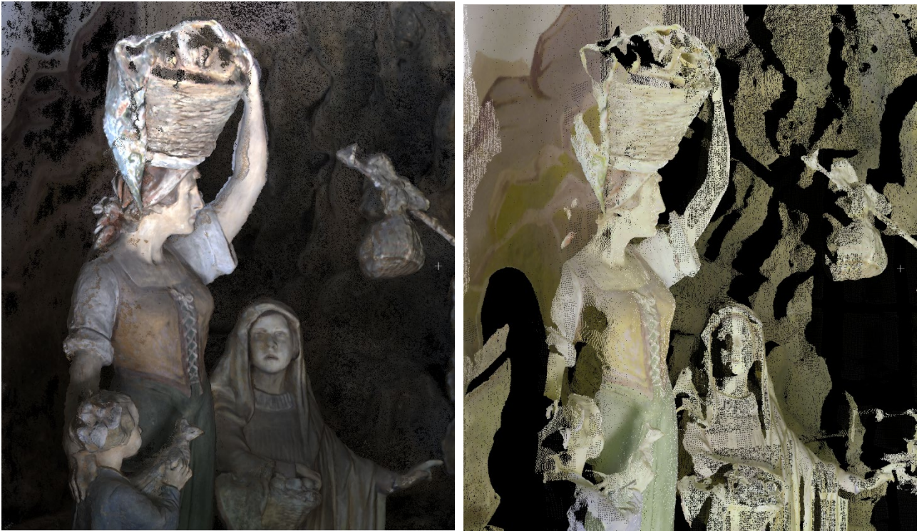
Figura 163: Confronto tra dettaglio statue Cappella 10 nella nuvola da Stonex XVS (sinistra) e Leica RTC 360 (destra).
