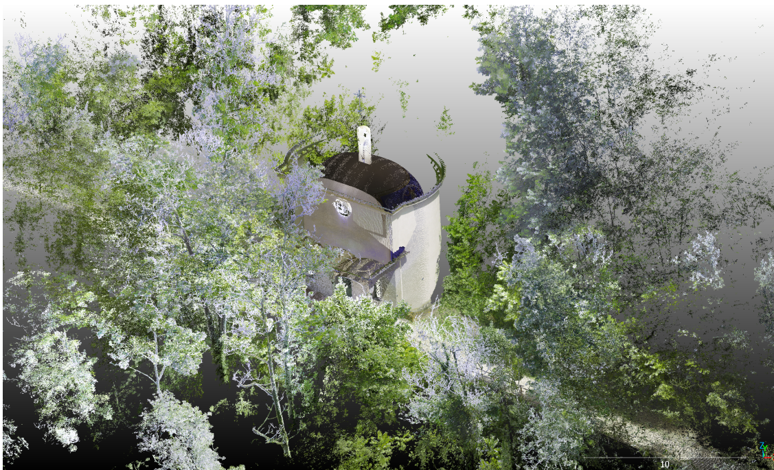
Figura 109: Nuvola di punti della Cappella 16 grezza.
