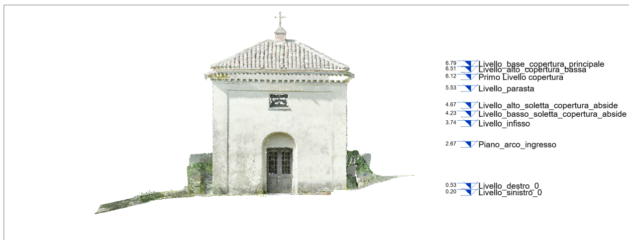
Figura 174: Definizione dei principali livelli per la modellazione.
