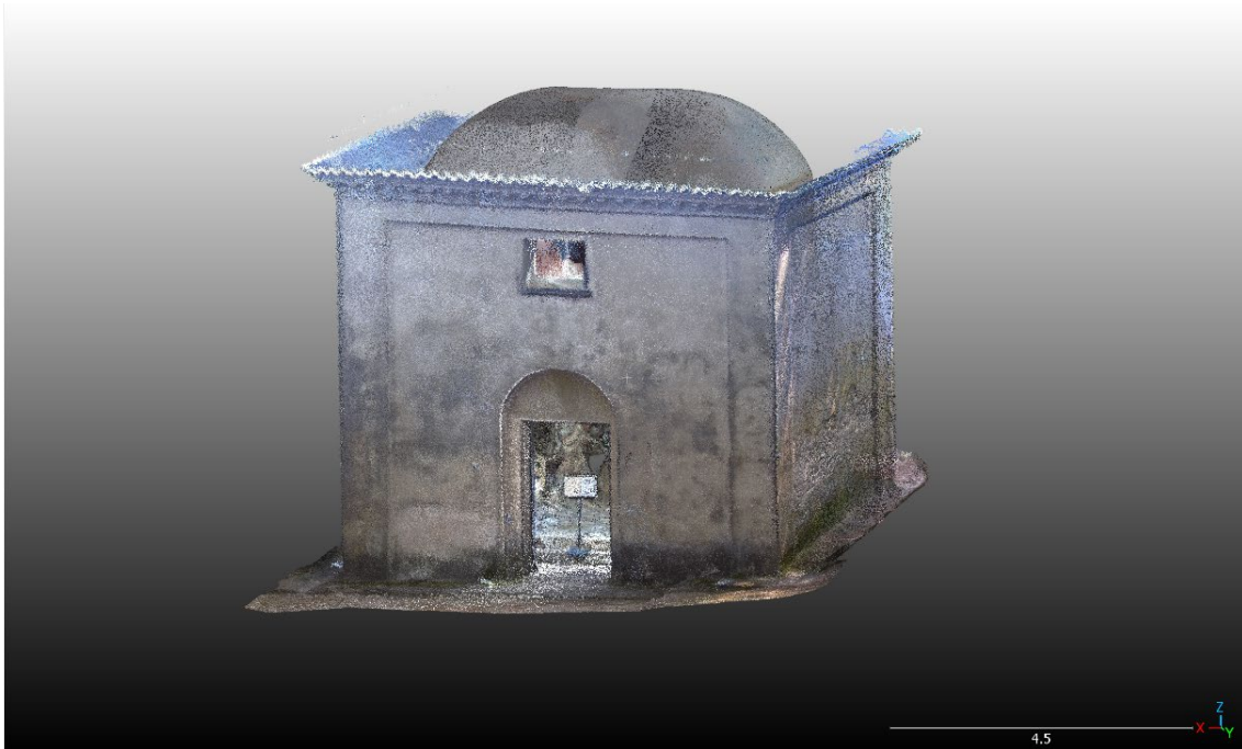
Figura 115: Nuvola di punti della Cappella 10 ripulita dalla vegetazione.
