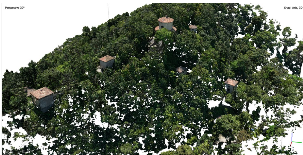
Figura 125: Nuvola densa Sacro Monte estratta dai fotogrammi DJI MAVIC 3M – lato Nord (fonte: Politecnico di Torino, Dipartimento DIATI).
