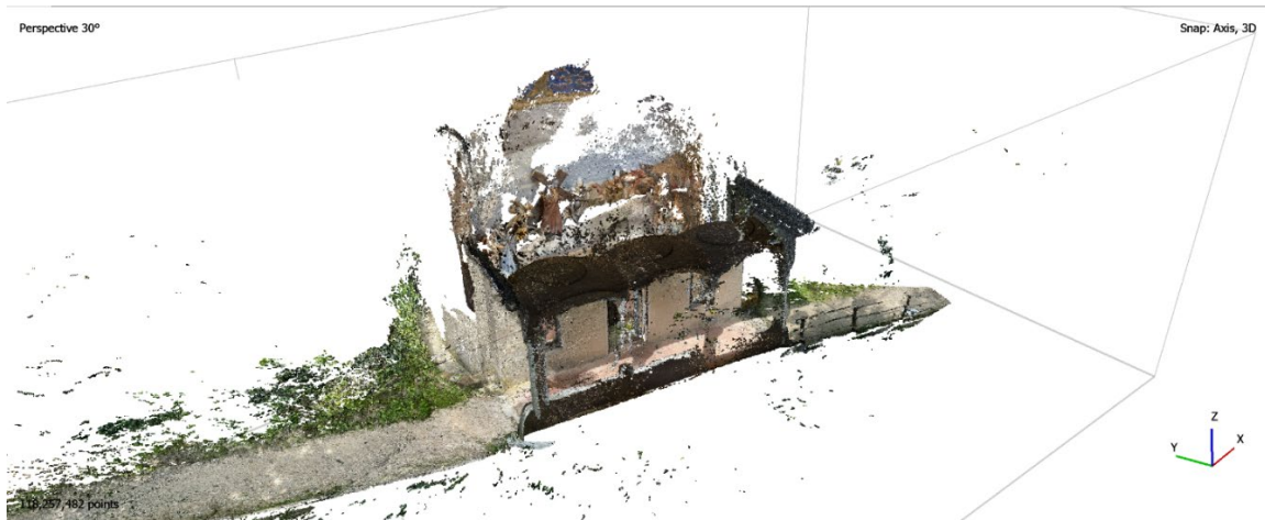
Figura 124: Nuvola densa Cappella 16 estratta da fotogrammi viDoc .
