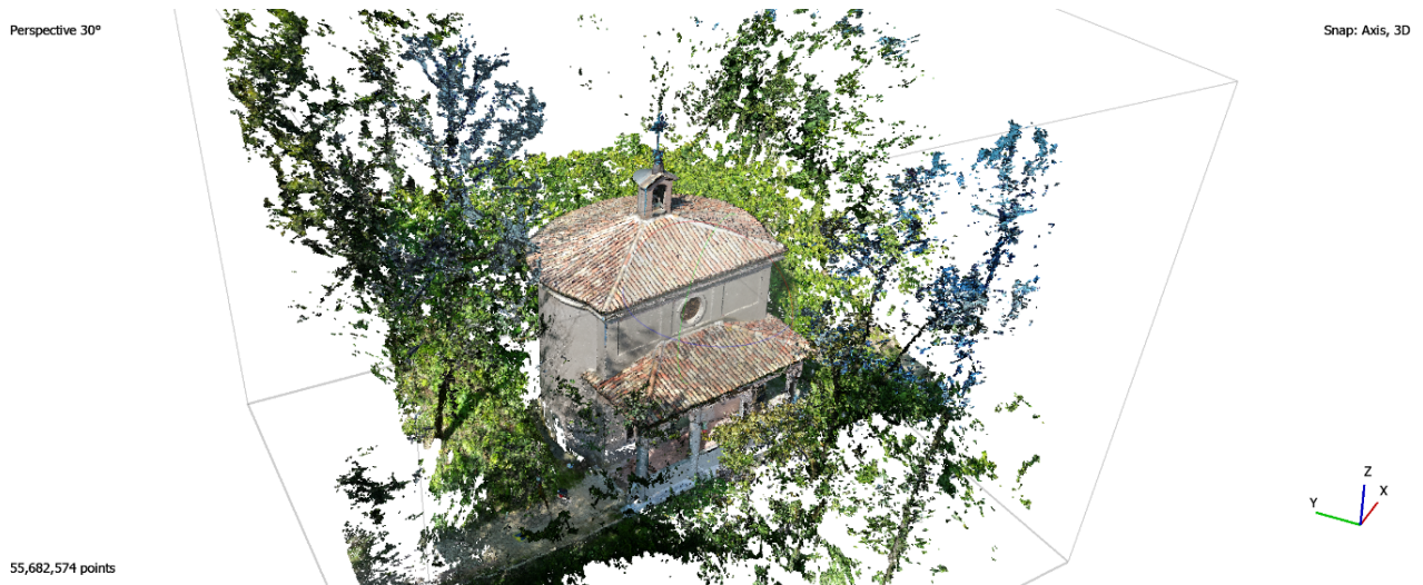
Figura 122: Nuvola densa Cappella 16 estratta da fotogrammi DJI Mini 3 PRO.
