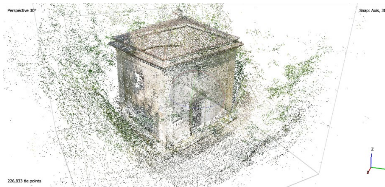
Figura 119: Nuvola Cappella 10 correttamente allineata.
