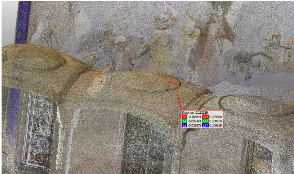
Figura 134: Effettiva distanza tra punti omologhi delle nuvole viDoc e RTC per la cappella 16 esternamente.
