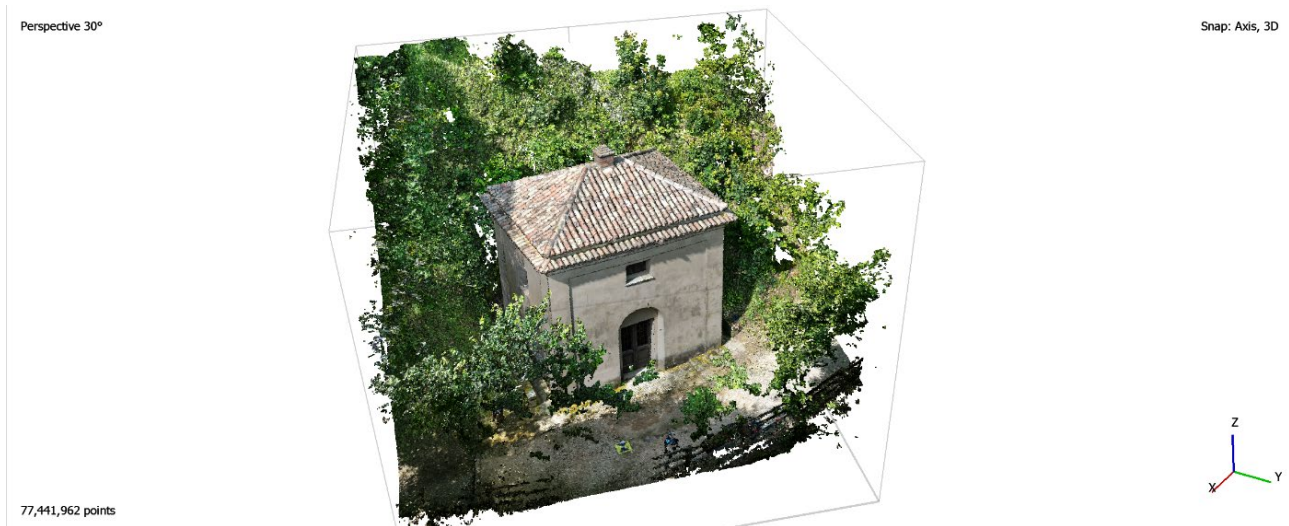
Figura 121: Nuvola densa Cappella 10 estratta da fotogrammi DJI Mini 3 PRO.
