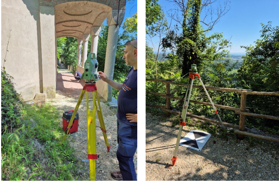
Figura 73: Stazione totale Leica Nova (sinistra) e prisma (destra).
