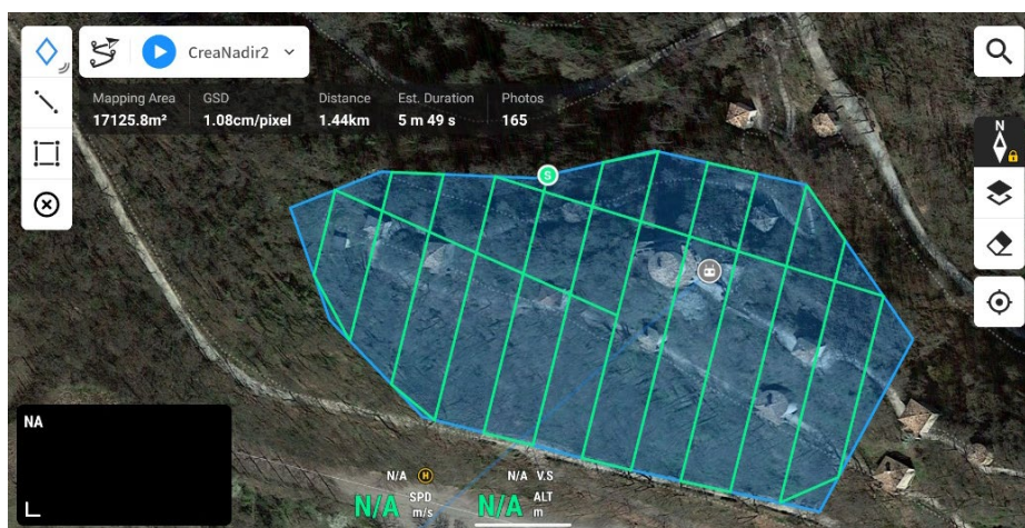
Figura 91: Seconda missione di volo nadirale.
