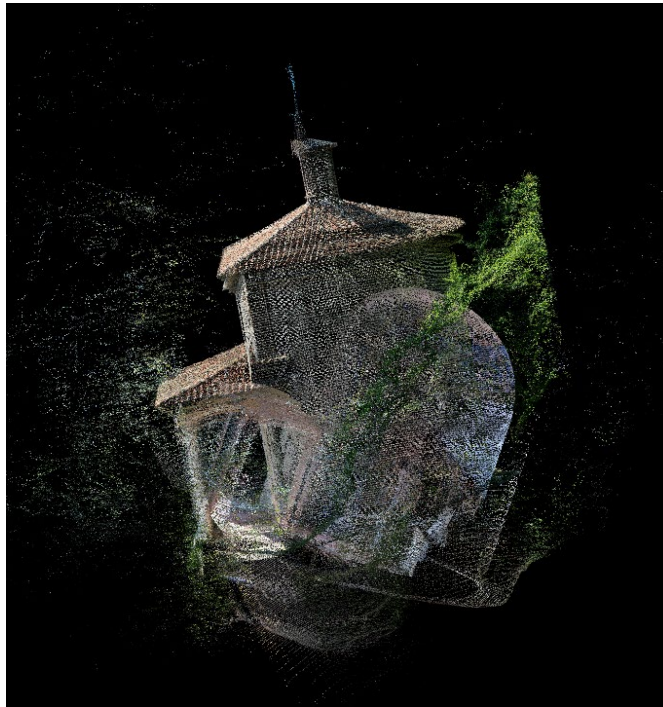
Figura 131: Mancata corretta georeferenziazione della nuvola da Stonex X70GO rispetto a nuvola fotogrammetrica da drone.
