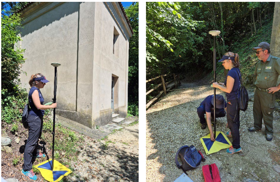
Figura 70: Posizionamento sui marker del Leica Smart Rover.
