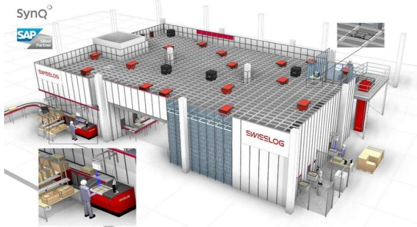
Figura 17. Sistema di immagazzinamento automatico AutoStore [11]
