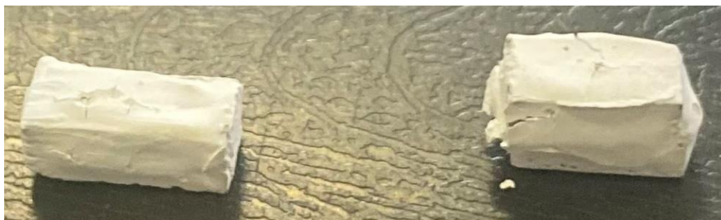
Figura 17: Giunzioni piatte costituite da due substrati in SiC/SiC prodotto da BJS e adesivo 890-VGF con rivestimento nitruro di boro consolidato.
