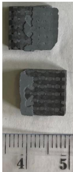
Figura 52: Campione di "Giunzioni 1" dopo il test meccanico.
