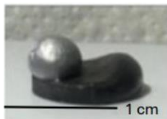
Figura 55: Pellet di vetro CA con sopra il frammento di lega metallica AlSi12 dopo il trattamento.
