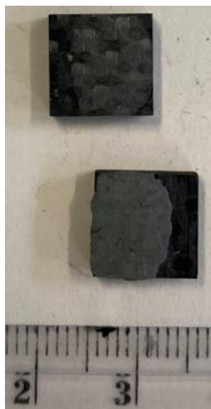
Figura 53: Campione di "Giunzioni 2" dopo il test meccanico.
