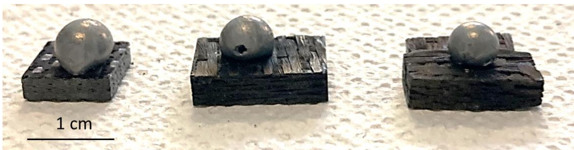
Figura 57: Substrati in SiC/SiC prodotti da BJS (sinistra) e ATL (centro) e giunzione di taglio costituita da substrati SiC/SiC prodotti da ATL e adesivo 890-VGF (destra) con lega AlSi12 dopo trattamento termico.
