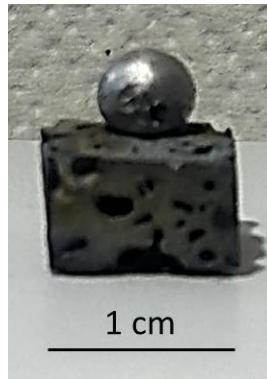
Figura 56: Pellet di adesivo 890-VFG con sopra il frammento di lega metallica AlSi12 dopo il trattamento termico.
