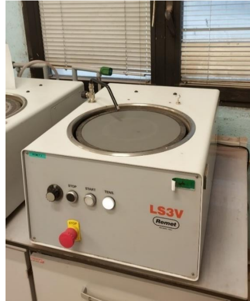
Figura 49: Levigatrice da banco orizzontale con carta di grado Z1000
