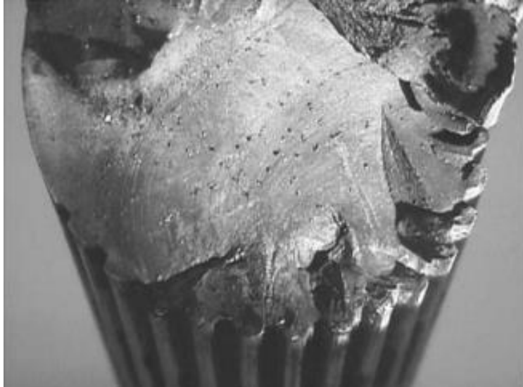
Figura 42: Albero di elica in 17-4 PH fratturato in seguito a SCC.
