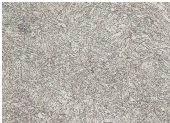
Figura 31: Micrografia di acciaio 17-4 PH in seguito ad attacco elettrolitico (200X).
