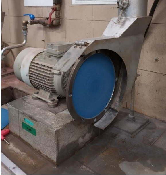
Figura 48: Levigatrice a banco con carta di grado Z60
