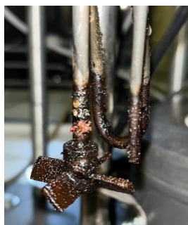
Figura 6.6: Girante in seguito al riscaldamento che ha preceduto la reazione HTC AL RISC
