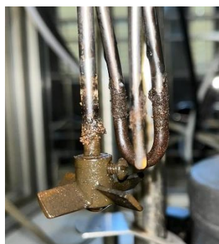
Figura 6.12 : Girante post reazione catalizzata da Pt/Al 2 O 3 di a) HTC SS; b) HTC AL
