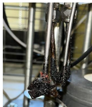
Figura 6.12 : Girante post reazione catalizzata da Pt/Al 2 O 3 di a) HTC SS; b) HTC AL
