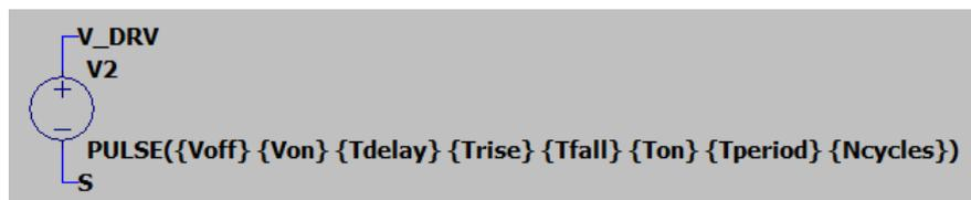
Figura 3.2: Generatore di tensione di pilotaggio.
