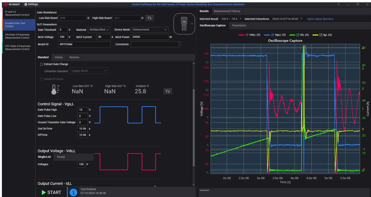
Figura 2.8: Schermata del software di controllo PD1000A.
