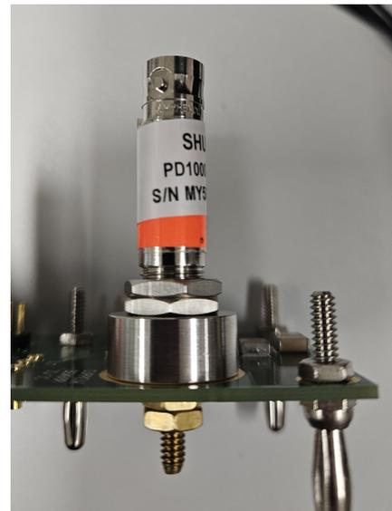
(b) Shunt per la misura di corrente montato sulla scheda per DUT.
