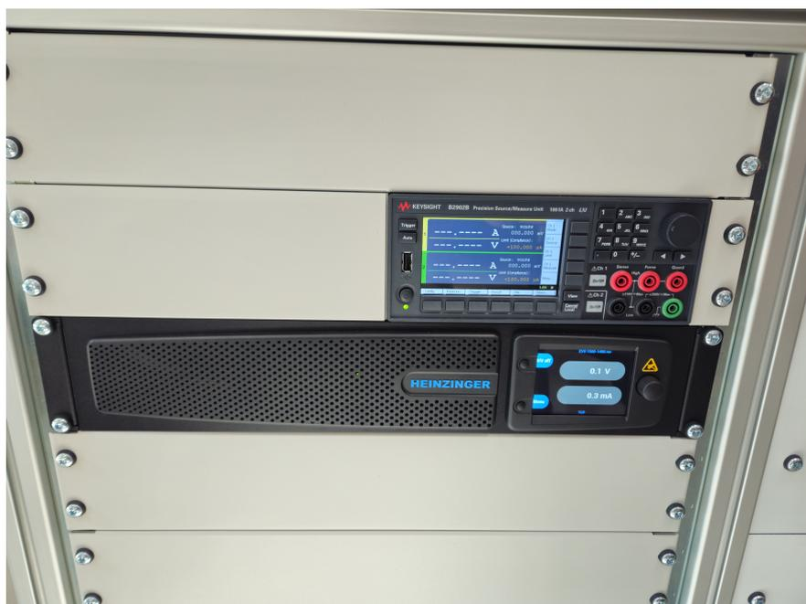
Figura 2.2: Alimentatore Heinzinger EVO e misuratore B2902B
