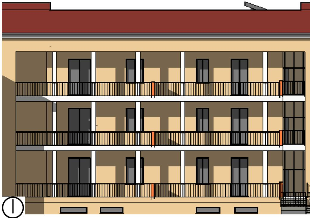
Figura 55: Studio delle ombre su parte del prospetto sud-ovest, alloggio C e D. Stralcio modello tridimensionale alle 18:00 del solstizio d'estate senza schermature solari.
