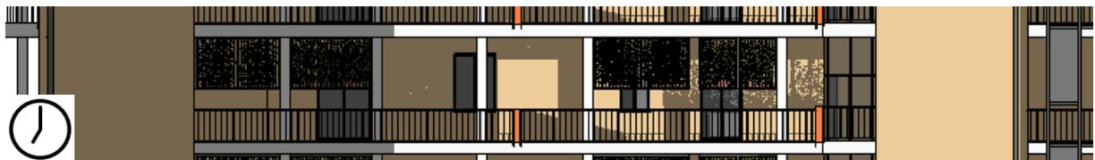
Figura 74: Studio delle ombre su parte del prospetto sud-ovest, alloggio C e D. Stralcio modello tridimensionale con andamento delle ombre al piano primo alle 19:00 del solstizio d'estate.
