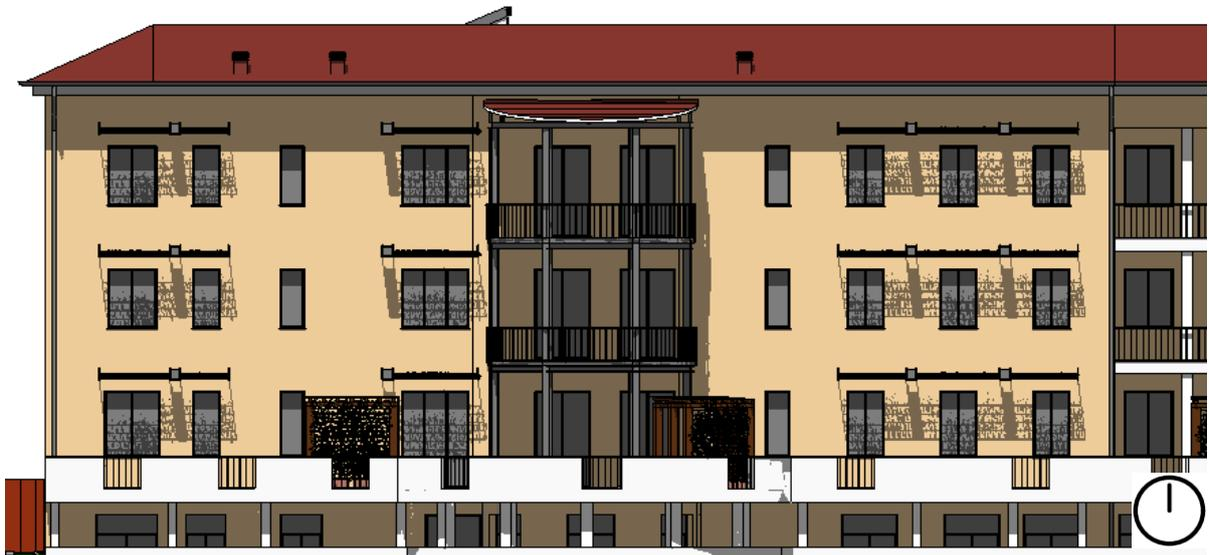
Figura 63: Studio delle ombre su parte del prospetto sud-est, alloggio E ed F. Stralcio modello tridimensionale alle 12:00 del solstizio d'estate.
