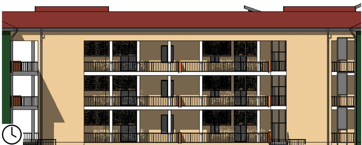
Figura 70: Studio delle ombre su parte del prospetto sud-ovest, alloggio C e D. Stralcio modello tridimensionale alle 16:00 del solstizio d'estate.
