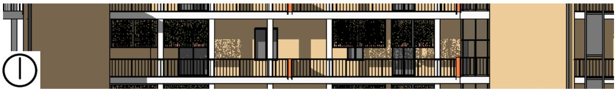
Figura 73: Studio delle ombre su parte del prospetto sud-ovest, alloggio C e D. Stralcio modello tridimensionale con andamento delle ombre al piano primo alle 18:00 del solstizio d'estate.
