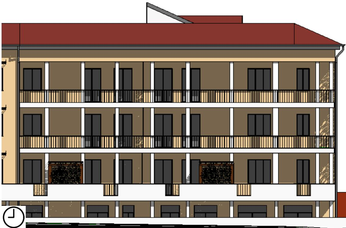
Figura 60: Studio delle ombre su parte del prospetto sud-est, alloggio G e H. Stralcio modello tridimensionale alle 09:00 del solstizio d'estate. Si possono notare le ombre portate sulla facciata prodotte dai pannelli forati.
