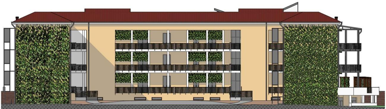
*Figura 76: prospetto sud-ovest con pareti con rivestimento verde. Sulla sinistra si notano le schermature previste a nord-ovest.*
