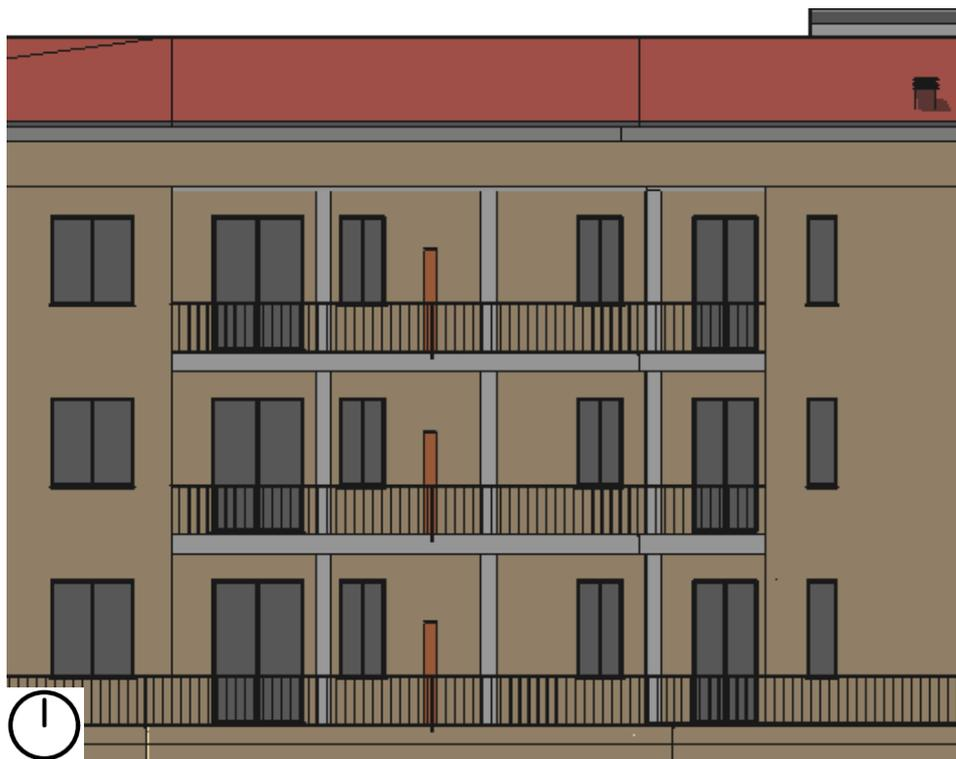
Figura 56: Studio delle ombre su parte del prospetto nord-est, alloggio C e D. Stralcio modello tridimensionale alle 12:00 del solstizio d'estate.
