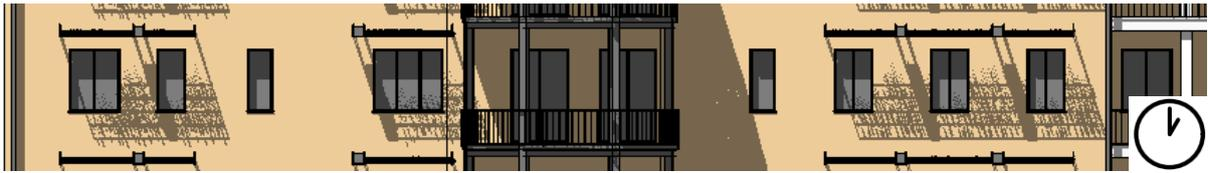
Figura 66: Studio delle ombre su parte del prospetto sud-est, alloggio E ed F. Stralcio modello tridimensionale con andamento delle ombre al piano primo alle 13:00 del solstizio d'estate.
