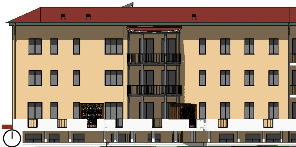
Figura 57: Studio delle ombre su parte del prospetto sud-est, alloggio E ed F. Stralcio modello tridimensionale alle 12:00 del solstizio d'estate senza schermature solari.
