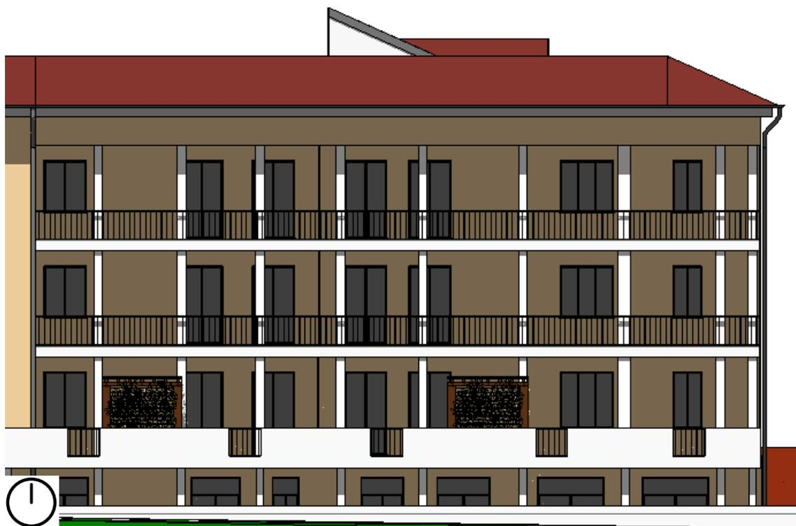
Figura 58: Studio delle ombre su parte del prospetto sud-est, alloggio G e H. Stralcio modello tridimensionale alle 12:00 del solstizio d'estate senza schermature solari.
