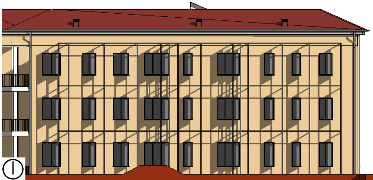
Figura 77: Studio delle ombre su parte del prospetto sud-ovest, alloggio A e B. Stralcio modello tridimensionale alle 18:00 del solstizio d'estate.
