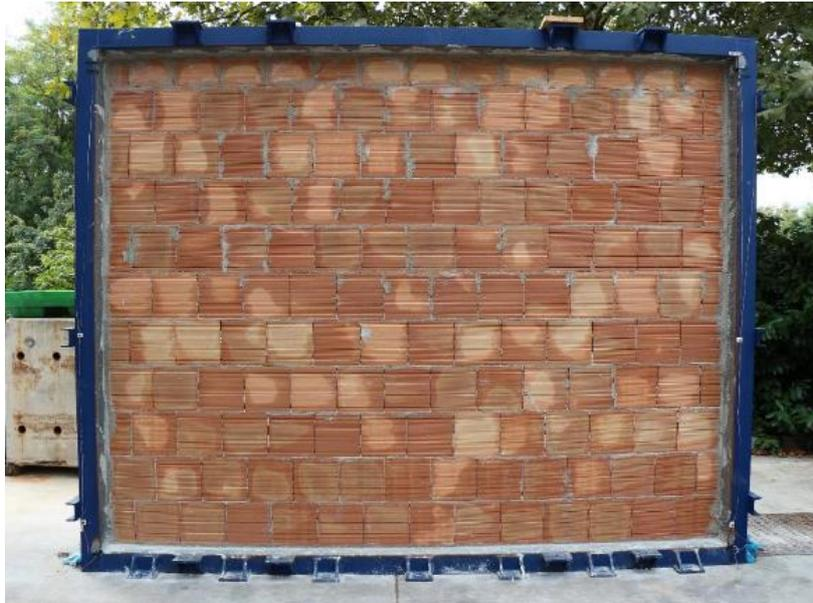
*Figura 21: Provino tipo al termine della costruzione [10].*
