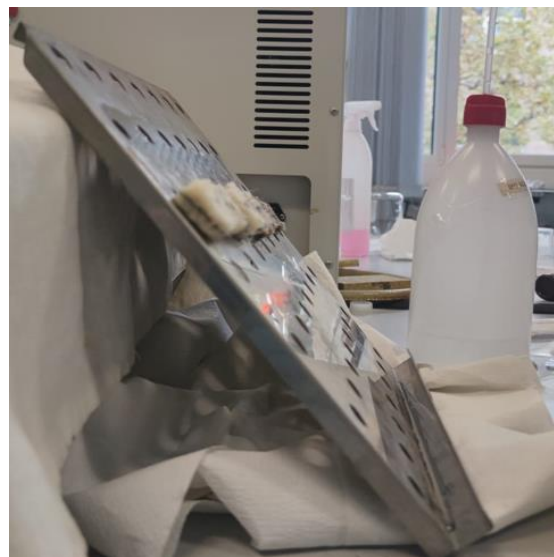
Figura 3.7 – Lastra di drenaggio inclinata a 45° - laterale.
