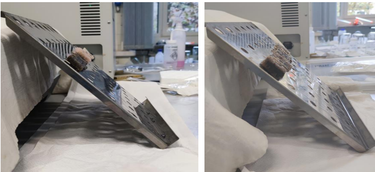
Figura 3.9 Lastra di drenaggio inclinata a 45° - laterale.
