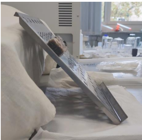
Figura 3.7 – Lastra di drenaggio inclinata a 45° - laterale.
