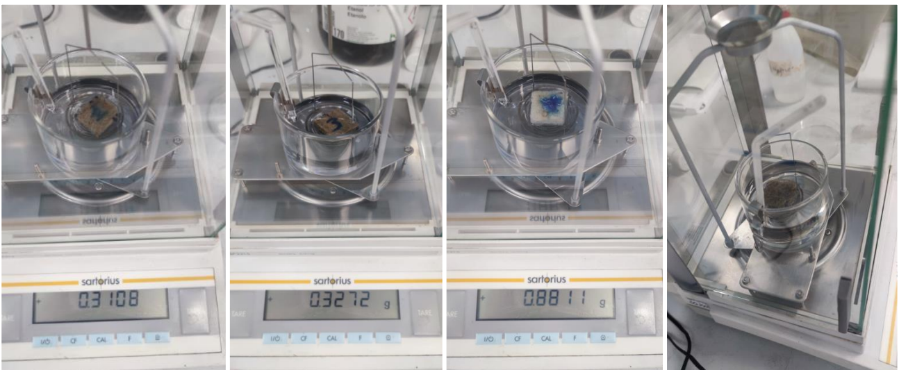
Figura 3.3 Provini pesati in alcool isopropilico.
