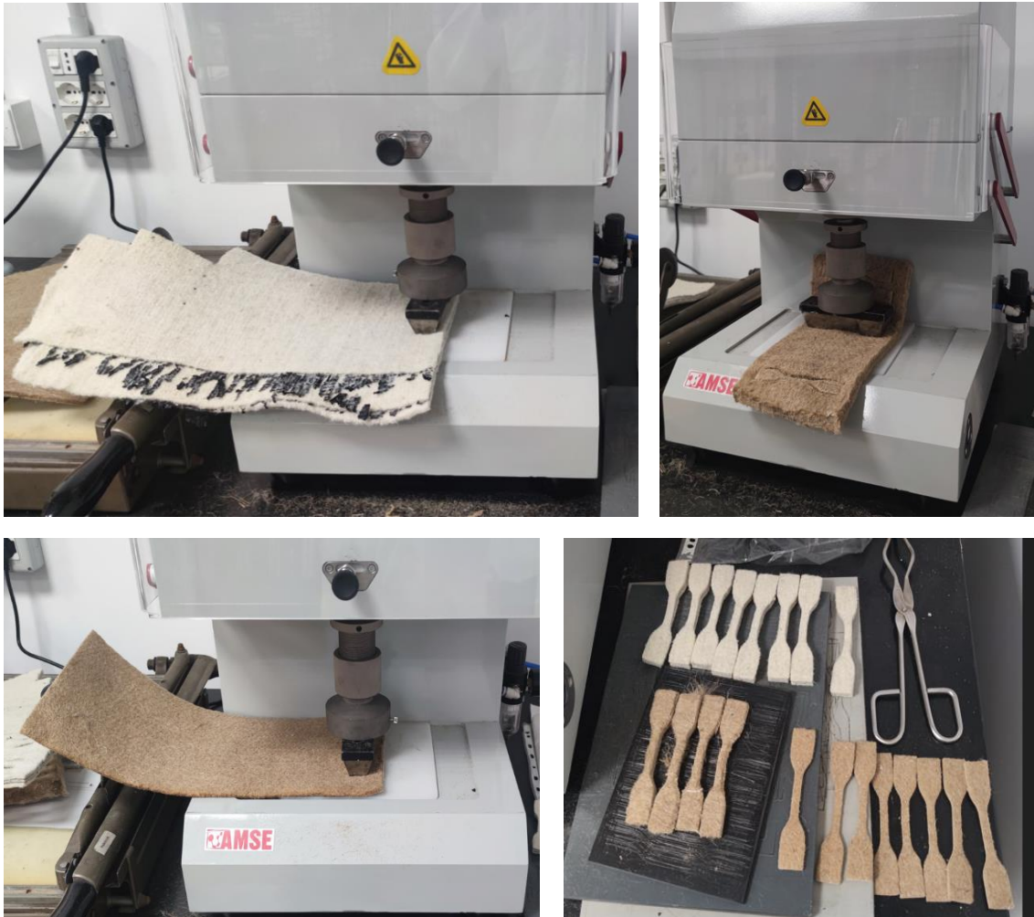
Figura 3.44 Pressa per realizzazione provini a forma di “osso di cane”.
