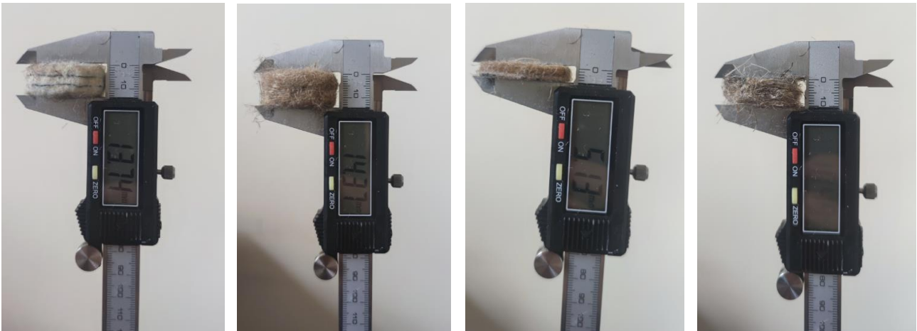
Figura 3.58 Misure dello spessore con calibro elettronico.
