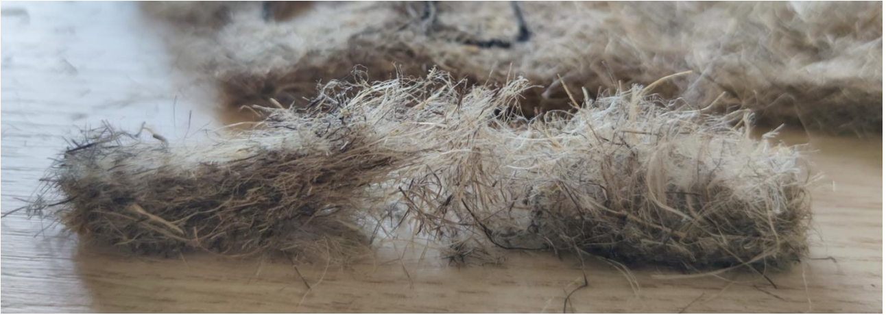
Figura 3.46 Provino sfaldato di Canapa-Wave™.
