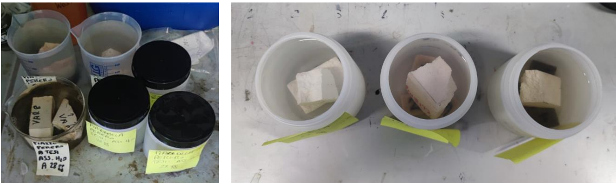
Figura 3.8 – Becher con campioni totalmente immersi in acqua.
