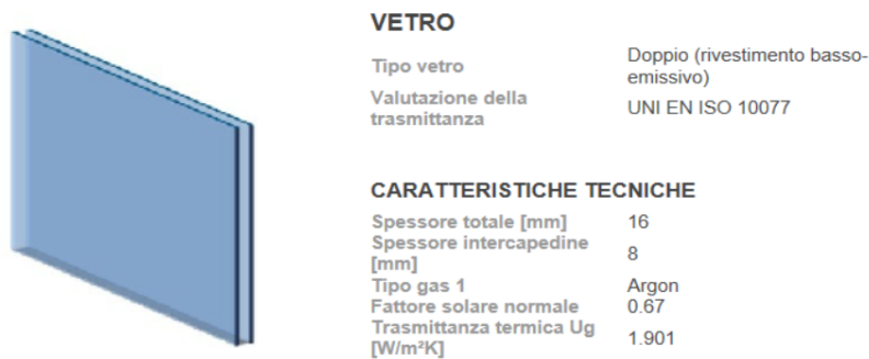
Figura 4.6 Doppio vetro con rivestimento basso-emissivo.
