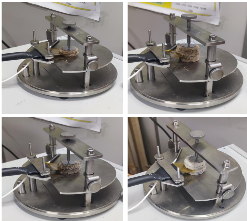
Figura 3.59 Posizionamento campioni su Hot Disk Thermal Constants Analyser.
