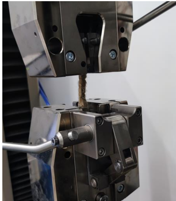
Figura 3.49 Rottura per trazione del provino JKI™.
