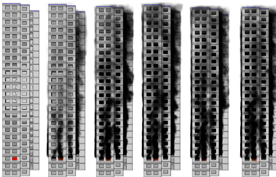
Figura 4.20: Propagazione dei fumi dal 3° piano dell'edificio con fasce di separazione a 0, 200, 400, 600, 800 e 1000 s
