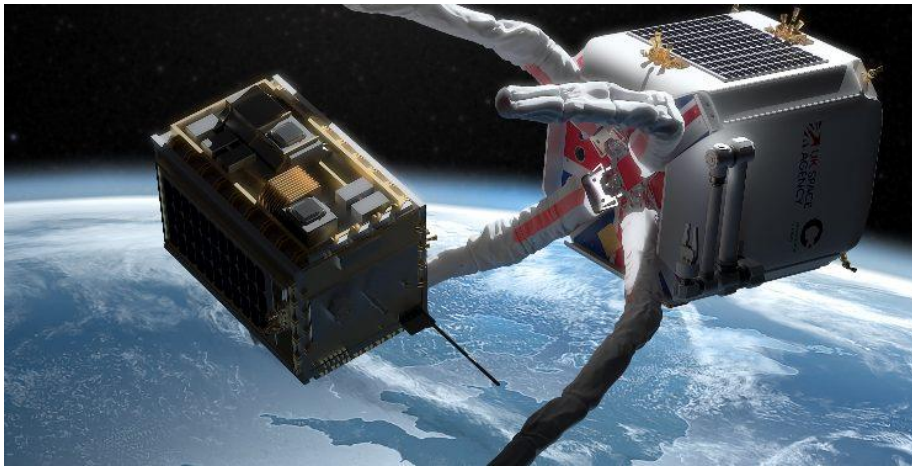
Figura 5: Braccio meccanico per la rimozione attiva dei detriti.
