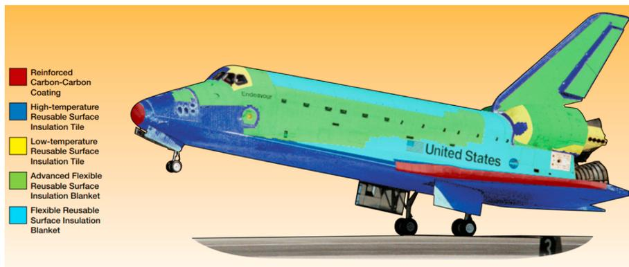
Figura 1.3: Dispositivi di protezione termica impiegati sullo Space Shuttle
