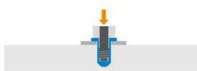
*Figura 9.3: Step 2 installazione rivetto filettato*
