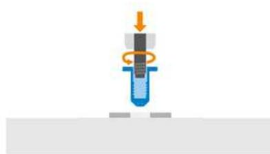
*Figura 9.2: Step 1 installazione rivetto filettato*
