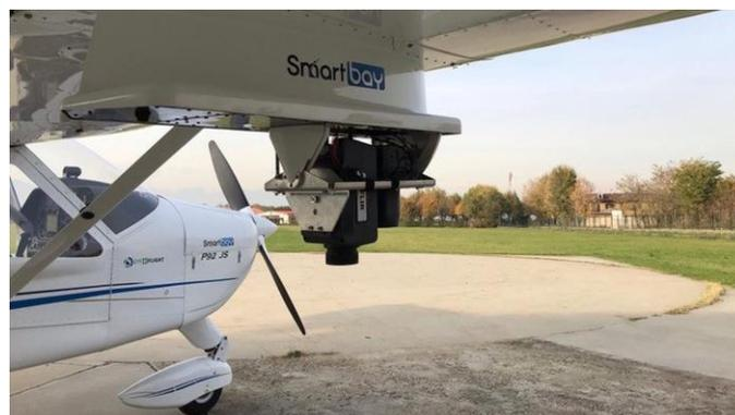
Figura 1.2: Piattaforma SmartBay© installata sul velivolo Tecnam P92
