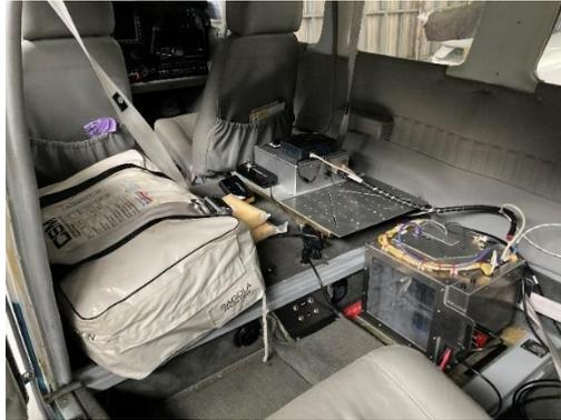
Figura 1.3: Piattaforma SmartBay© installata sul velivolo Piper PA32-R300
