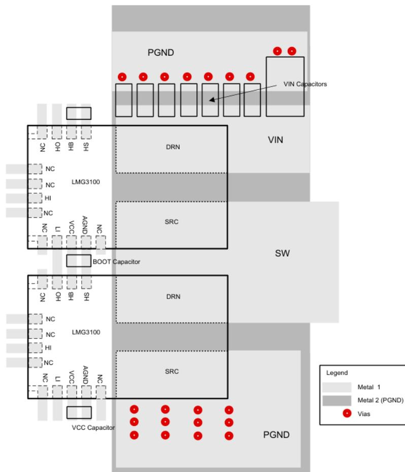
Figura 2.12: Esempio di Connessione per PCB [10]
