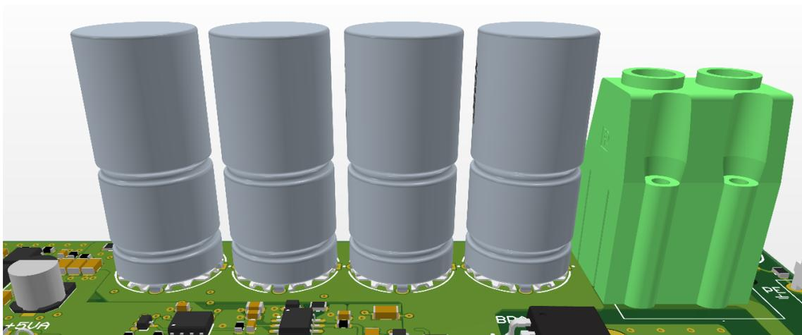
Figura 5.20: Visione Tridimensionale dei Componenti del *DC-link*
