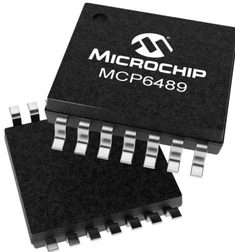
Figura 4.25: Operazionale MCP6489T-E/ST [24]
