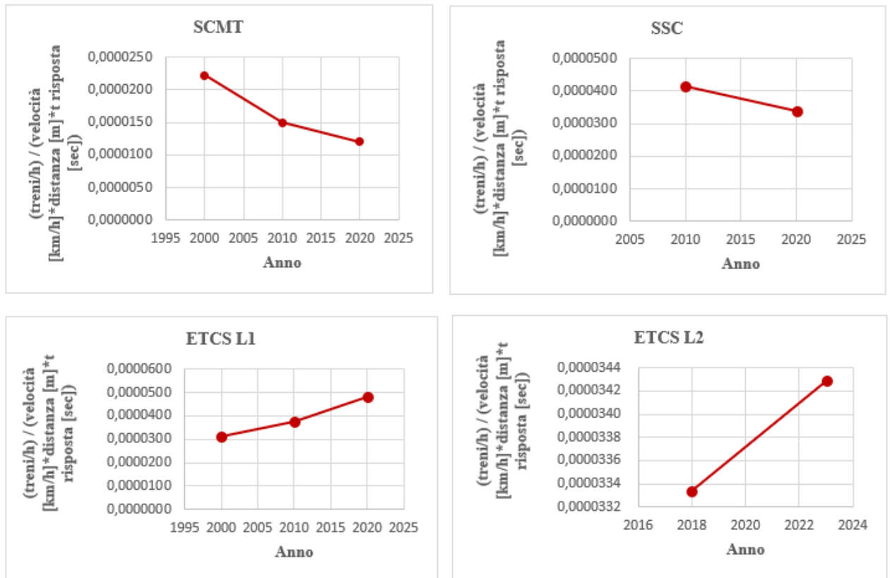
Figura 18- Andamento dell'indicatore di performance "Capacità" nel tempo per le tecnologie SCMT, SSC, ETCS L1 e ETCS L2
