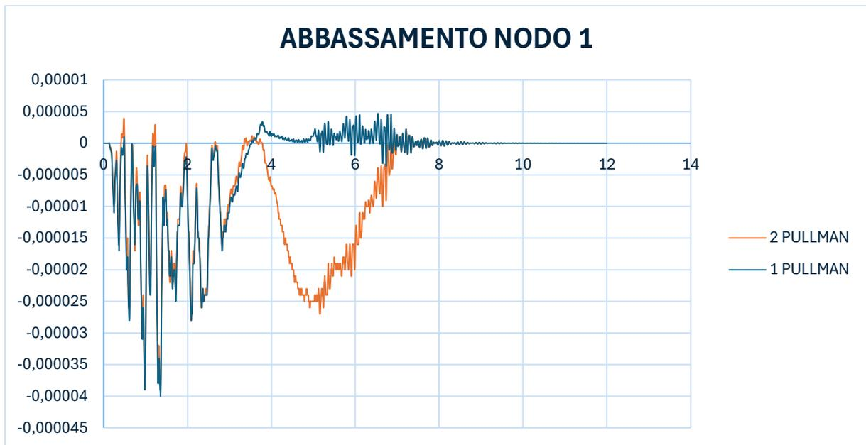
Figura 100. Confronto uno e due pullman abbassamento nodo 1
