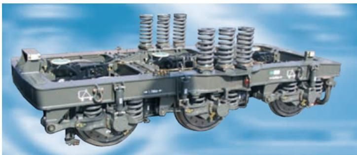
Figura 2.12: Carrello Siemens Vectron SF6 per la locomotiva ER20CF
