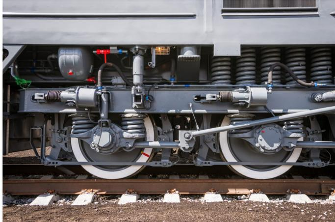
Figura 1.15: Esempio di un veicolo ferroviario con un doppio stadio di sospensioni
