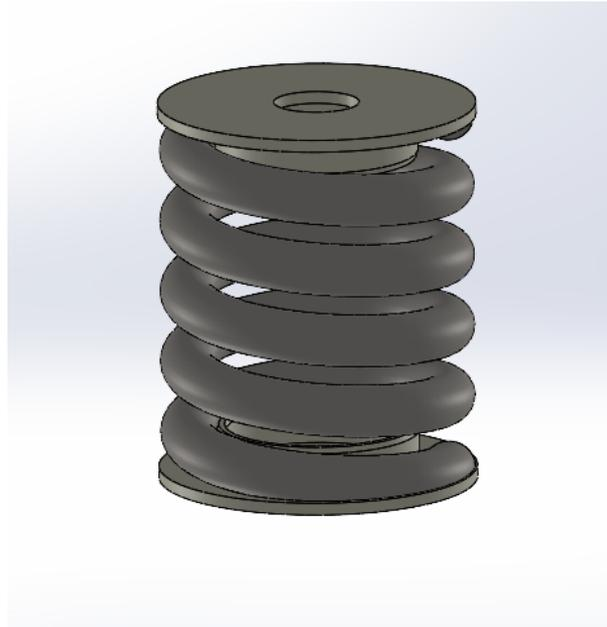
Figura 7.6: Modello CAD 3D del pacco molla monoelica delle sospensioni primarie
