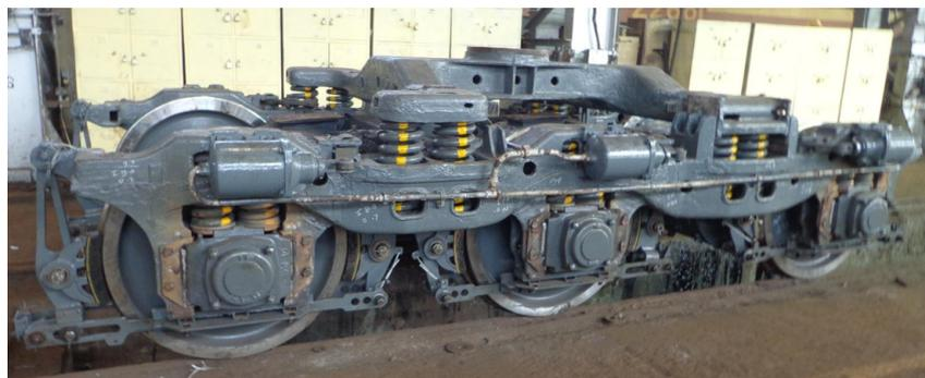
Figura 4.8: Carrello Mark-1 con sistema di sospensione flexicoil totale e ralla di trascinamento
