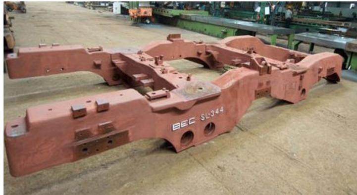
Figura 1.12: Telaio per un carrello ferroviario a tre assi
