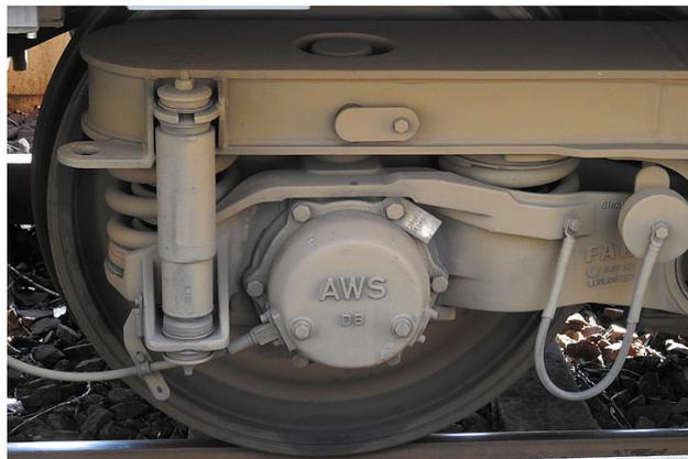
Figura 1.16: Esempio di uno smorzatore verticale sul primo stadio
