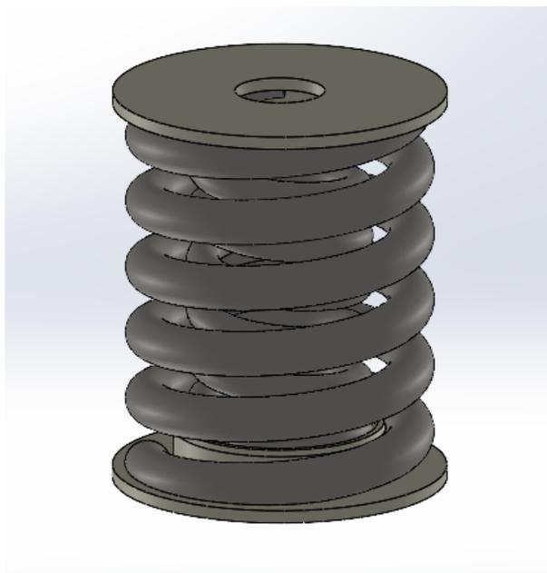
Figura 7.1: Modello CAD 3D del pacco molla a doppia elica delle sospensioni primarie
