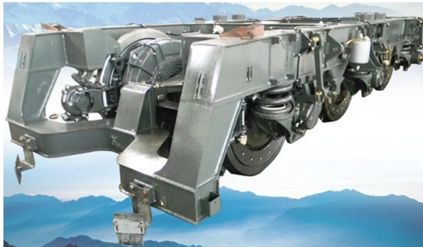
Figura 2.17: Carrello 160 km/h di CRRC
