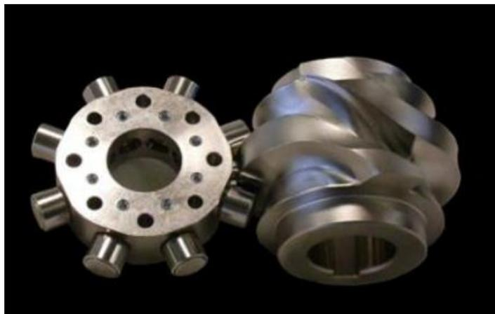
Figura 3.2 Meccanismo a camma globoidale
