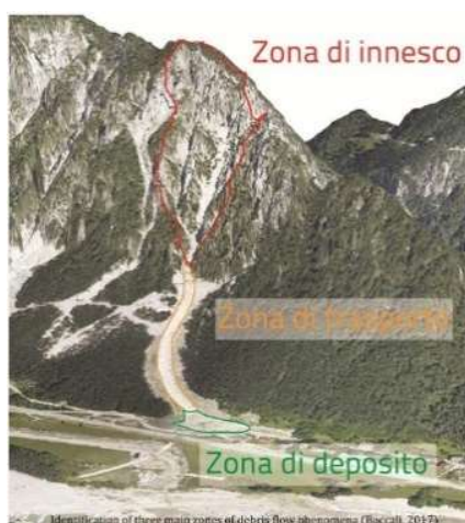
Figura 2.3: Schema degli spazi di sviluppo di un debris flow
