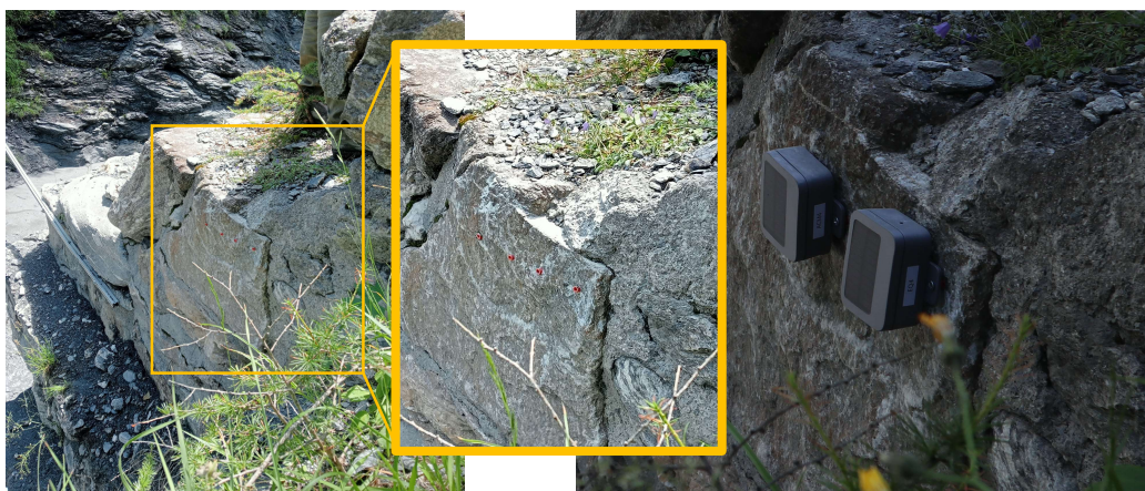
Figura 5.12: Fasi dell'installazione di accelerometri e sismometri, tramite tasselli
