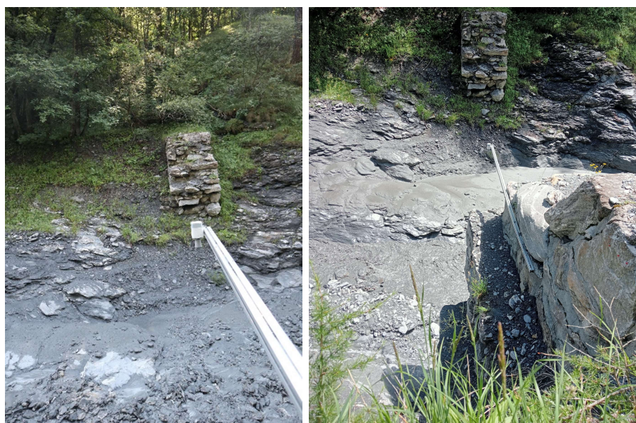
Figura 5.23: Differenze nell'altezza dell'alveo successivamente all'evento del 30 luglio (sinistra) e del 31 luglio (destra), in corrispondenza del sensore di livello WLM1
