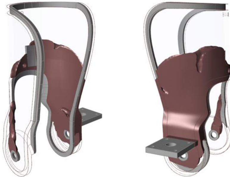
Figura 81- Risultato ottimizzazione della struttura superiore in chiusura
