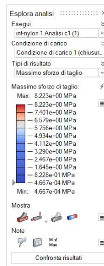
Figura 77- Massimo sforzo di taglio in chiusura della struttura inferiore (PA 12)
