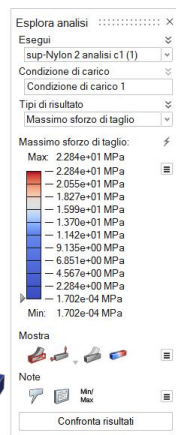
Figura 74- Massimo sforzo di taglio in chiusura della struttura superiore (PA 12)
