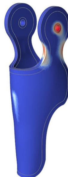
Figura 69- Fattore di sicurezza in chiusura della struttura inferiore (PA 12)
