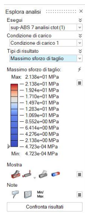
Figura 105- Massimo sforzo di taglio nella struttura superiore (ABS)
