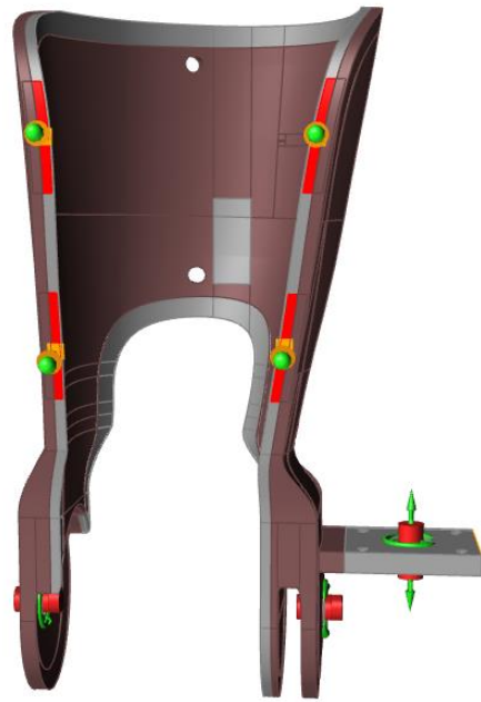
Figura 52- Vincoli sugli attacchi (struttura superiore)
