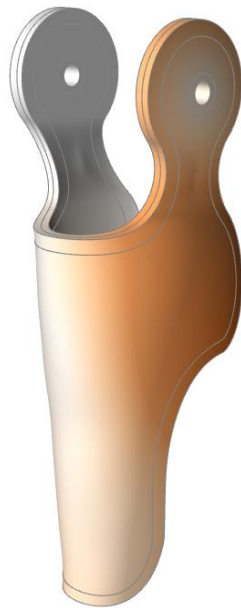
Figura 63- Spostamento totale della struttura inferiore (ABS)
