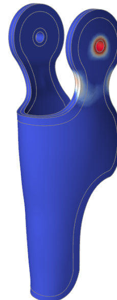
Figura 72- Fattore di sicurezza in chiusura della struttura inferiore (PA 12)
