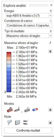
Figura 76- Massimo sforzo di taglio in apertura della struttura superiore (ABS)
