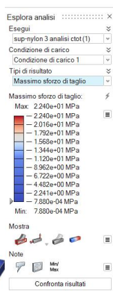
Figura 104- Massimo sforzo di taglio nella struttura superiore (PA 12)
