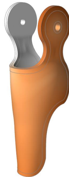
Figura 60- Spostamento in apertura della struttura inferiore (PA 12)
