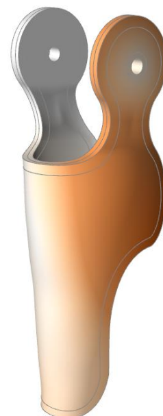
Figura 62- Spostamento in chiusura della struttura inferiore (PA 12)
