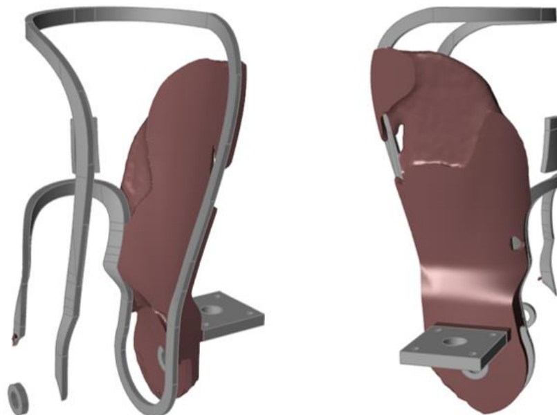
Figura 82- Risultato ottimizzazione topologica della struttura superiore in apertura
