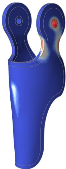
Figura 70- Fattore di sicurezza in chiusura della struttura inferiore (ABS)
