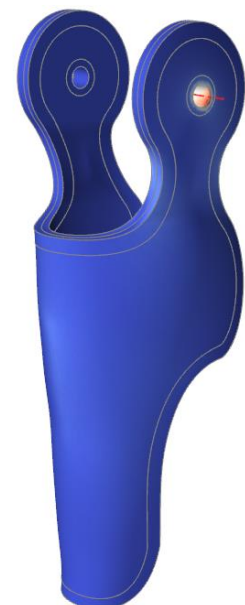
Figura 77- Massimo sforzo di taglio in chiusura della struttura inferiore (PA 12)
