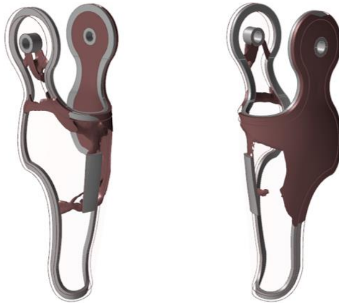
Figura 85- Risultato ottimizzazione della struttura inferiore in apertura
