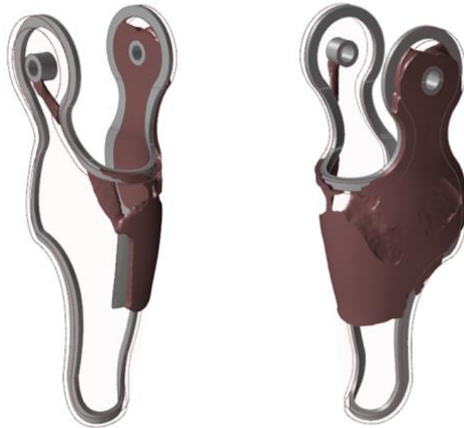
Figura 86- Risultato ottimizzazione della struttura inferiore con carico totale
