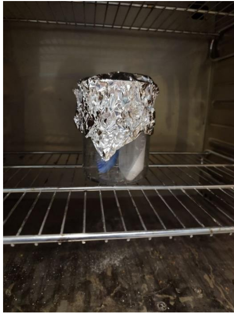
Fig. 14 Inserimento delle polveri S44BCu e S4 in stufa per essere essiccate
