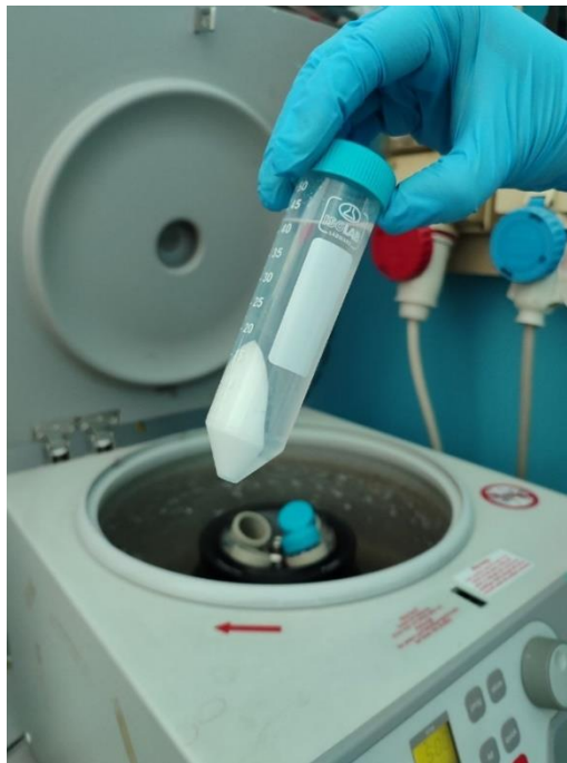
Fig. 11 Raccolta delle nanoparticelle di silice
