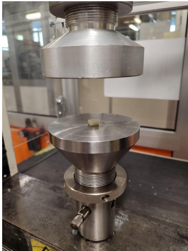
Fig.29 Prova di Compressione dei provini post stampa 3D
