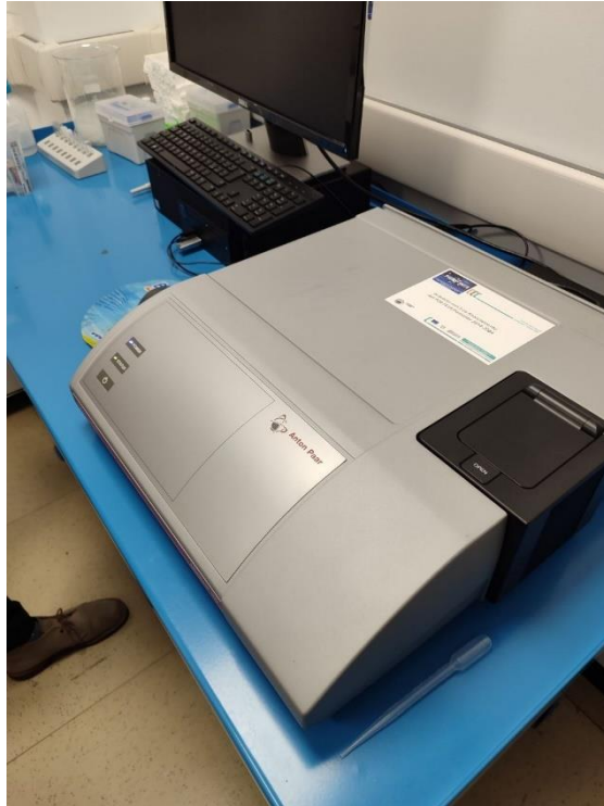
Fig.23 Strumento Anton Paar, per la misura del potenziale zeta e diametro idrodinamico
