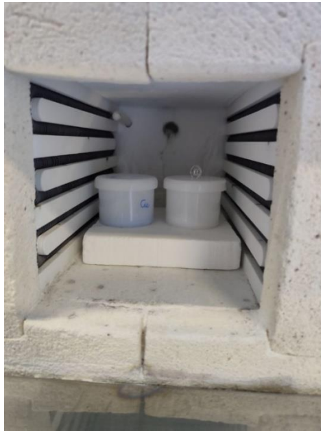
Fig. 16 Crogioli con le polveri di S4BCu e S4 in forno
