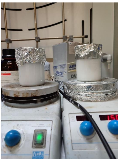
Fig. 9 Formazione di nanoparticelle di silice
