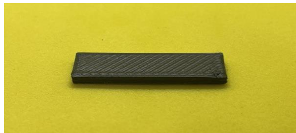
Figura 48: Campioni realizzati mediante tecnica FFF con strumento Roboze One sottoposti a DMA.
