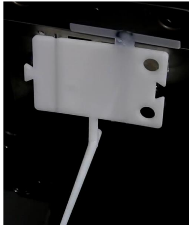
Figura 99: Formazione di bave nella zona superiore dello stampo, in corrispondenza dell'alloggiamento delle viti per il posizionamento dell'inserito nello stampo, che ha richiesto l'estrazione manuale dei pezzi 1, 2, 3 e 10.
