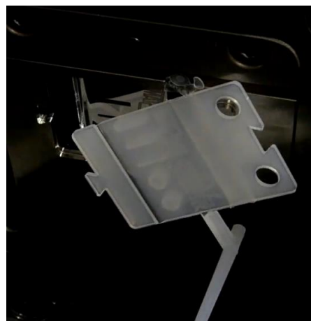
Figura 70: Formazione di bave nella zona dell'alloggiamento delle viti per il posizionamento dell'inserto nello stampo ad iniezione che ha richiesto l'estrazione manuale dei pezzi 6 e 7.
