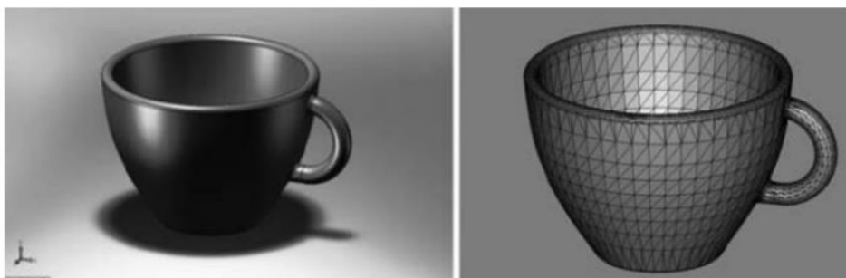
Figura 1: Modello CAD di una tazzina (sinistra) e relativa conversione in file STL (destra). [2]
