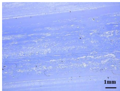
Figura 140: Porzioni di inserto asportate rilevate nella zona laterale della superficie degli stampati riprodotta.
