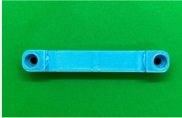
Figura 157: Inserto in G-PLA dopo l'esecuzione di 20 cicli di stampaggio ad iniezione.
