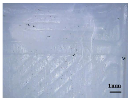
Figura 80: Asportazione di porzioni di inserto rilevate nella zona laterale e centrale della superficie riprodotta.
