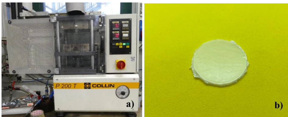
Figura 26: (a) Pressa a piani paralleli riscaldati Collin P200 T, (b) tipologia di campione realizzato con la pressa a piani paralleli riscaldati per l'esecuzione delle prove reologiche.
