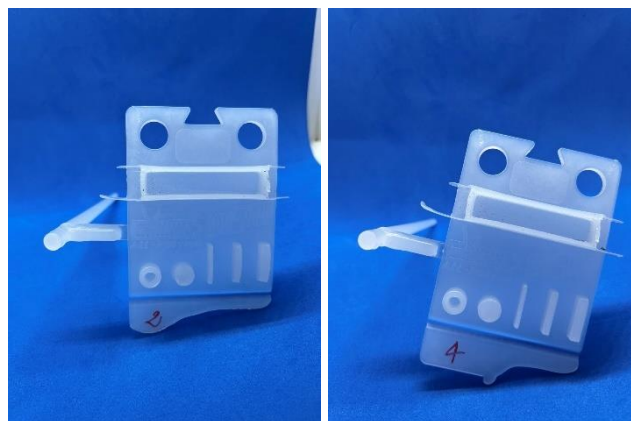
Figura 85: Parti incomplete in LDPE realizzate con i cicli di stampaggio 2 (a) e 4 (b) utilizzando lo stampo dotato di inserto "Pool" in R-CPA.
