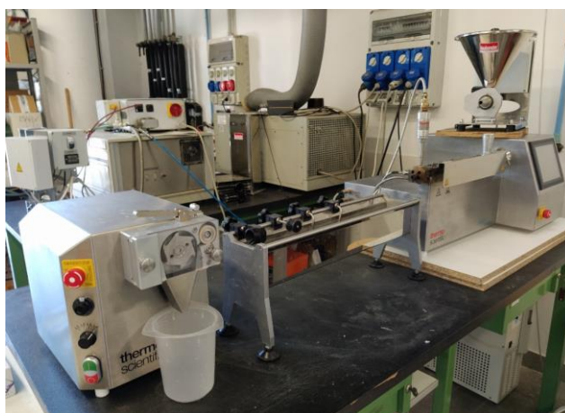
Figura 25: Estrusore bivate co-rotante Process 11 della Thermo Fisher Scientific™, dosatore volumetrico, vasca di solidificazione e taglierina per la pellettizzazione del filamento estruso.
