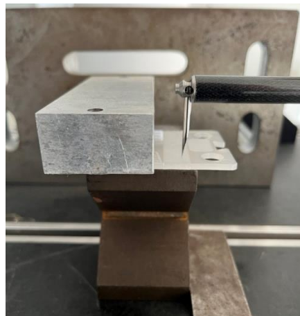
Figura 42: Esecuzione delle prove di misurazione del profilo mediante profilometro Mahr Marsurf CD 120.
