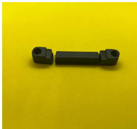
Figura 95: Inserto “Pool”, prodotto in R-CPA, fratturatosi al momento dell’estrazione dallo stampo dopo le prove di iniezione di LDPE.
