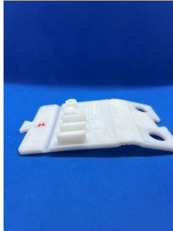
Figura 132: L'estrazione manuale dei pezzi 1 e 3 ha prodotto la deformazione della superficie riprodotta e l'imbarcamento dello stampato.
