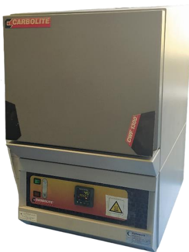
Figura 55 - Il forno "Carbolite CWF 1300" sfruttato per il post-trattamento dei corpi verdi precedentemente stampati
