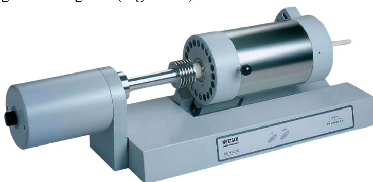
Figura 47 - Il dilatometro "Netzsch DIL 402 PC" utilizzato sui pellet sinter-cristallizzati di VBA
