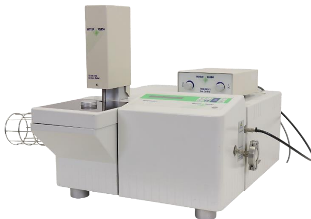
Figura 48 - Il "Mettler Toledo TGA 851e" è la macchina utilizzata per l'analisi termogravimetrica della resina grezza
