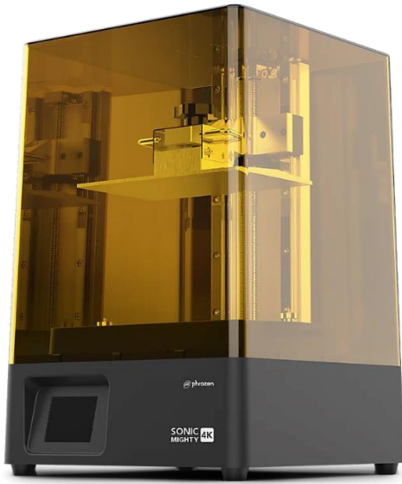
Figura 52 - La stampante "Phrozen Sonic Mighty 4K" con cui si sono stampati i provini DMTA
