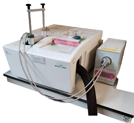
Figura 49 - Il "Mettler Toledo DSC-1" assieme alla lampada "Hamamatsu Lightningcure LC8-L9588" (a Dx) usati per l'analisi di fotocalorimetria sulle resine
