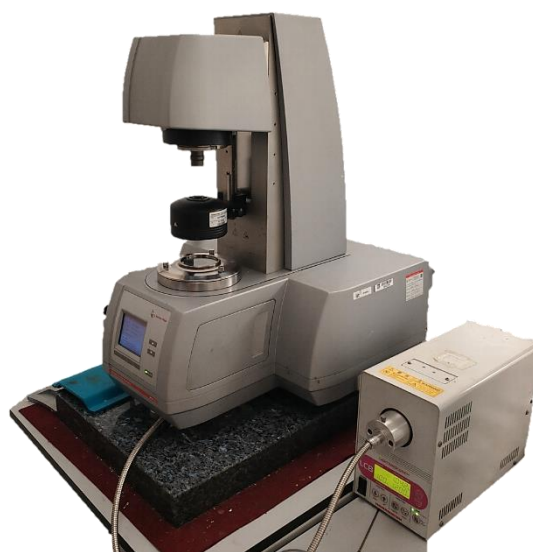
Figura 50 - Il reometro "Anton Paar MCR 302" già montato per le prove fotoreologiche (a Dx si vede la lampada Hamamatsu LC8)
