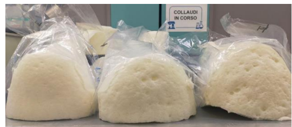
Figura 44 – Test del sacchetto: Esempi di cuscini con qualità decrescente da sinistra a destra
