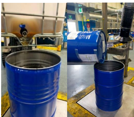
Figura 50 – “Premixing” di catalizzatori (immagine sinistra) e siliconi (immagine destra) in due fusti distinti
