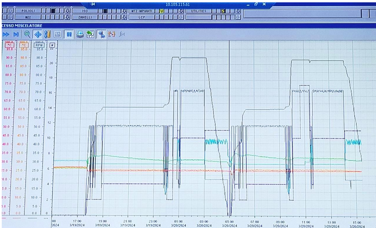
Figura 48 – Trend operativo di due prodotti realizzati nel medesimo miscelatore
