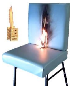
Figura 35 Prova al fuoco CRIB
