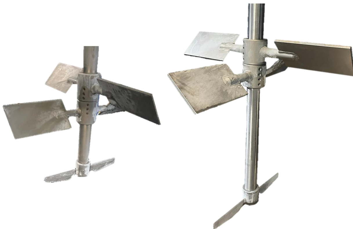
Figura 55 –Ekato Pitched Blade Turbine 45° di M14, M19 e M20
