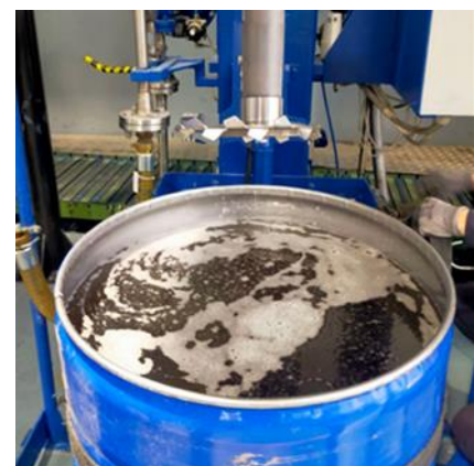
Figura 64 – Miscelazione in fusto presso impianti AK 200
