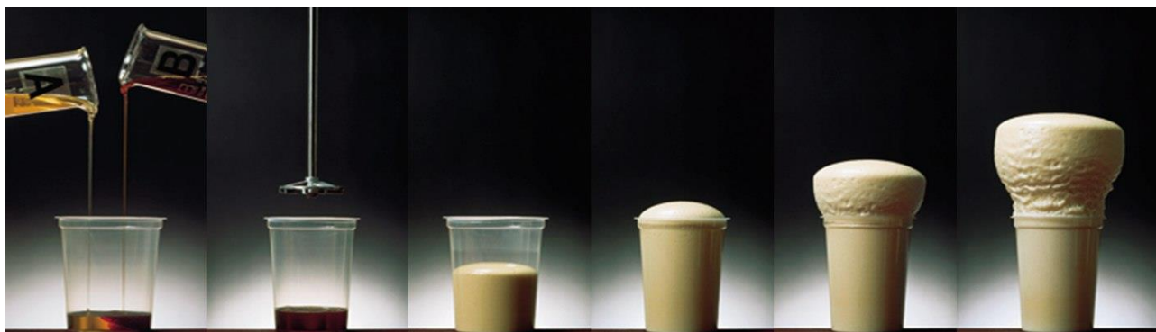
Figura 39 – Step di reazione tra isocianato e poliolo con produzione di schiuma poliuretanica (Fonte: Materiale BASF)
