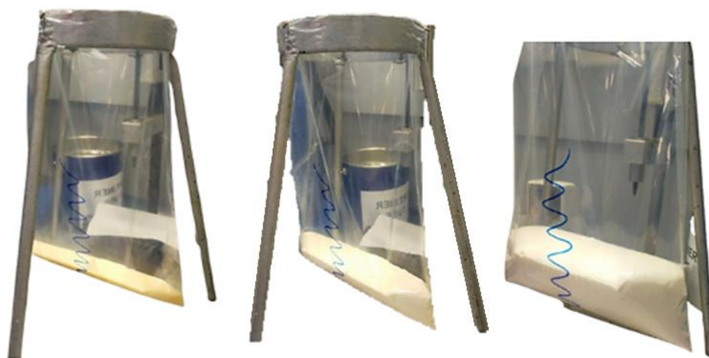
Figura 45 – Prova di reattività in libera: schiuma in espansione nel sacchetto
