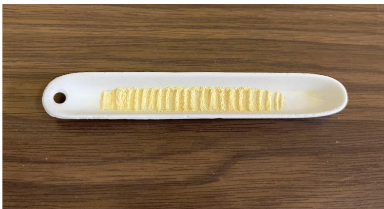
Figura 52: Polvere di ceria su navicella post calcinazione.
