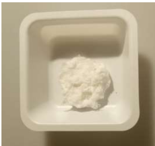
Figura 36: Campione pretrattato con 2% (w/v) NaOH e 14% (w/v), per 6 ore, a -20°C
