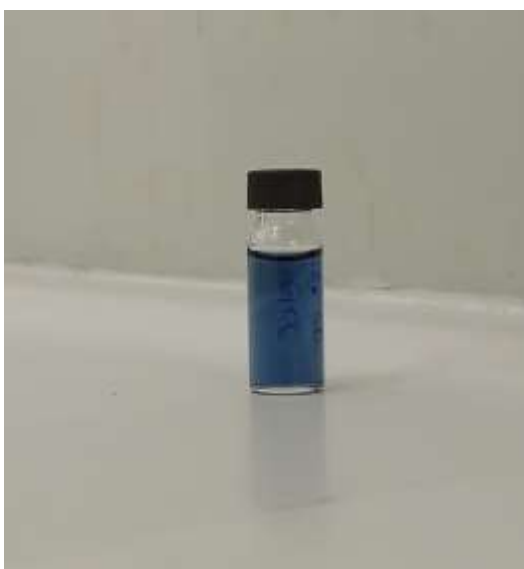
Figura 48: Campione di cotone colorato idrolizzato
