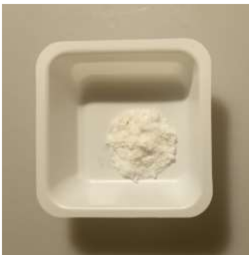
Figura 34: Campione pretrattato con 12% (w/v) NaOH, per 6 ore, a -20°C
