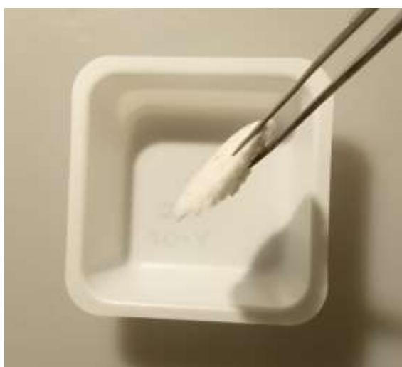
Figura 35: Campione pretrattato con 12% (w/v) NaOH, per 6 ore, a -20°C
