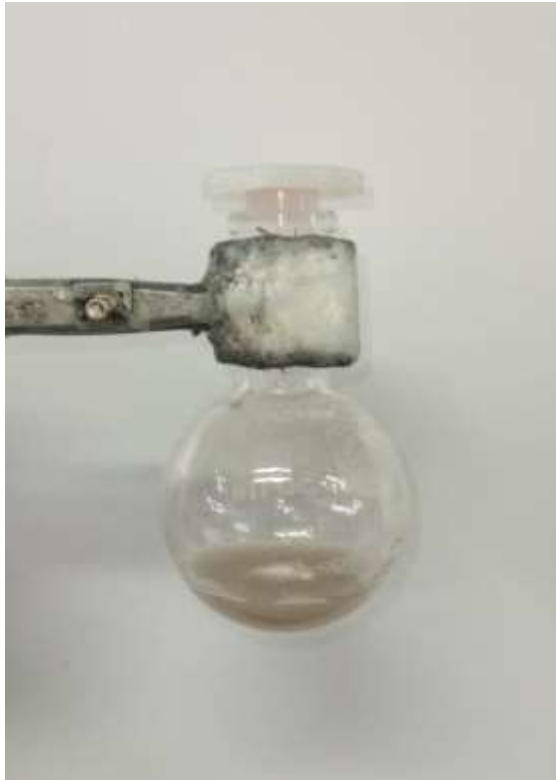
Figura 27: Prodotto di un'idrolisi della durata di 1,5 ore, condotta a 40°C, con un upload del 7% (w/v) e una concentrazione di acido solforico del 50%
