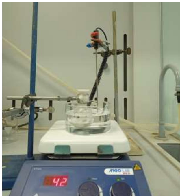
Figura 19: Setting per l'idrolisi acida con H_2SO_4
