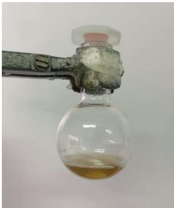
Figura 28: Prodotto di un'idrolisi della durata di 1,5 ore, condotta a 40°C, con un upload del 7% (w/v) e una concentrazione di acido solforico del 55%
