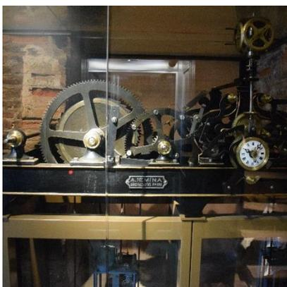
*Fig. 8* - Il vecchio meccanismo dell'orologio della torre, oggi in funzione elettronicamente (Alessandro Corrao©).
