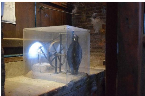
*Fig. 11* – Particolare del meccanismo del quadrante della fase lunare (Alessandro Corrao©).
