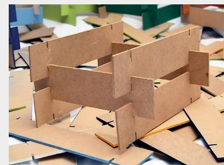
Fig. 75: Esempio cartotecnico di giunto per incastro per piani (Vecera, 2021).
