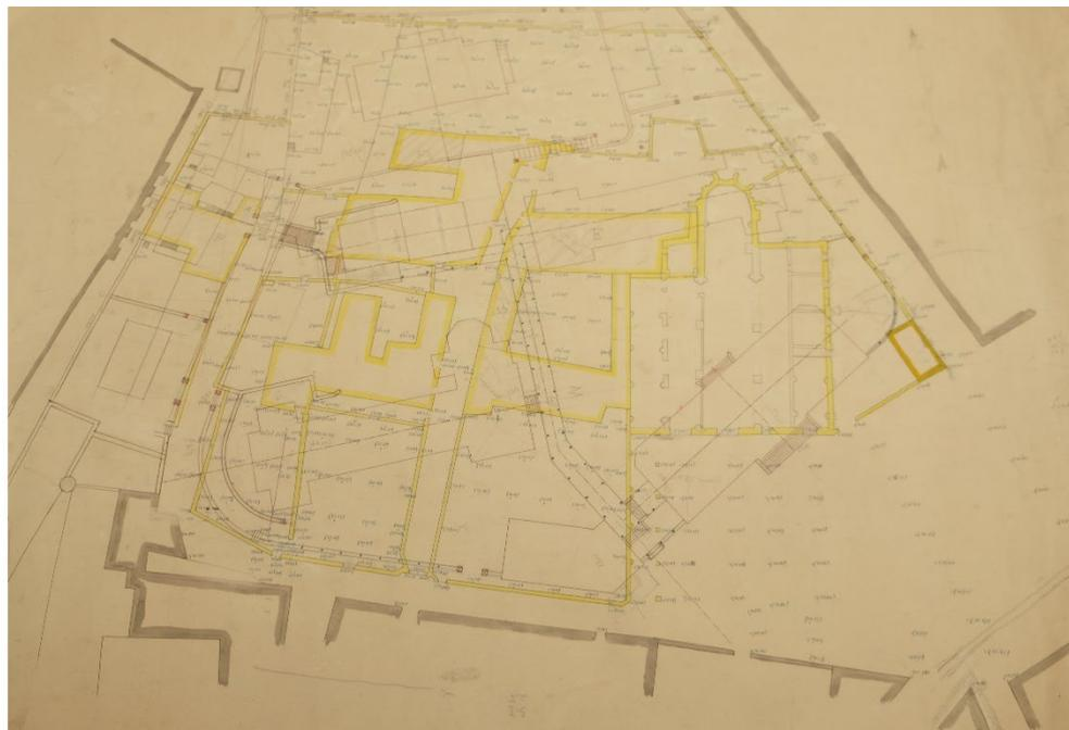
F. 39. Versione alternativa de il progetto per Ospedale da inserirsi a Pinerolo in affaccio su Piazza XX Settembre. Planimetria generale raffigurante le demolizioni necessarie per la realizzazione del progetto (ADP, Materiale non ancora indicizzato)
