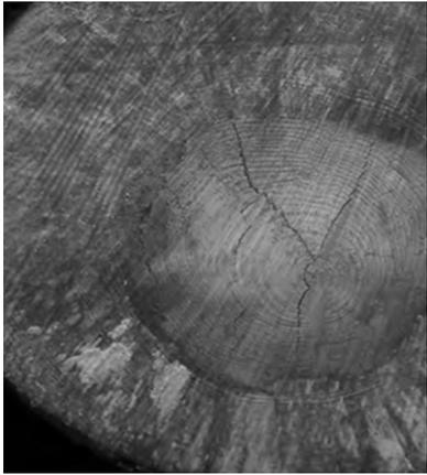
**Fig. 46/** Pith cracks in pine wood. Source: Wdowiak, Agnieszka. *Defects in structural timber (Wady drewna konstrukcyjnego). Structure & Environment, 9 (2). pp. 112-122. ISSN 2081-1500*
