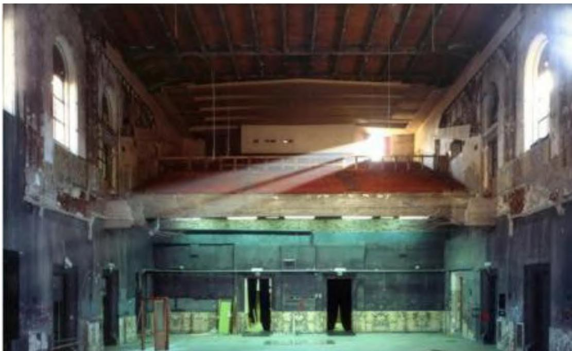
Fig. 166: Fotografia della sala prima dei lavori di ristrutturazione del 2006 in cui viene demolita la galleria e installata la gradinata retrattile. Fonte: Sito internet Teatro Astra TPE (Teatro Piemonte Europa)
