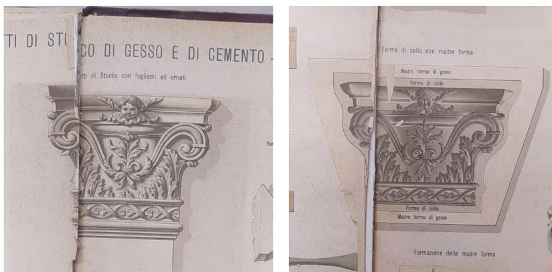
Figg. 113-114: Dettaglio di getti di stucco con fogliami ed ornati e madre forme di gesso. Fonte: Musso, G. e Copperi, G. (1912). Particolari di costruzioni murali e finimenti di fabbricati, Torino, G. B. Paravia, tav. L
