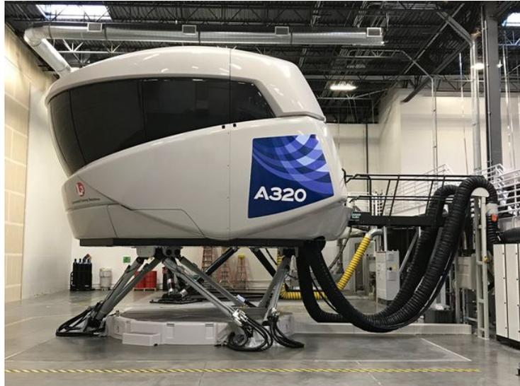
**Figura 2.26:** Airbus A320neo Full Flight Simulator di livello D [71]
