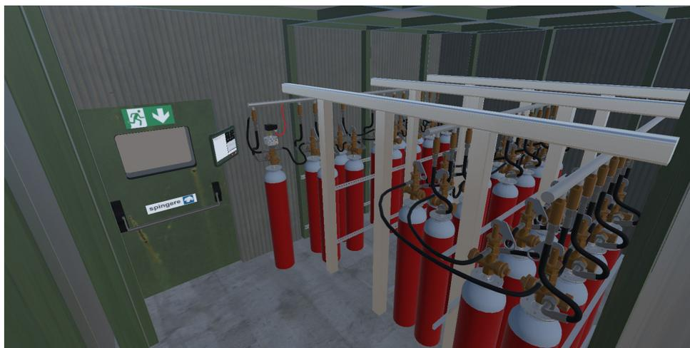
**Figura 5.4:** Modello 3D del CO2 Enclosure Store
