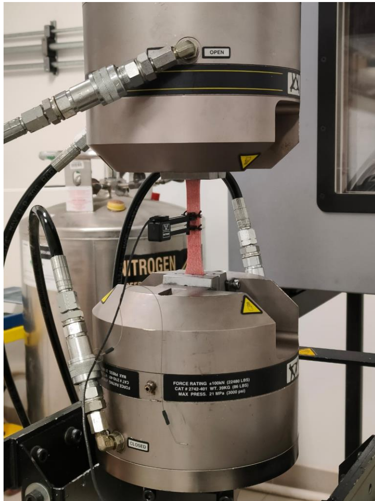
Figura 3.42 Provino "1" con estensometro monoassiale
