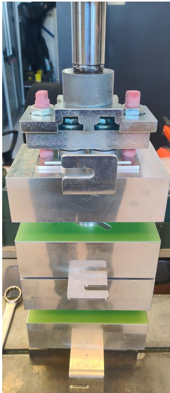
Figura 3.54 Applicazione del carico di serraggio sotto pressa del TECMV-X
