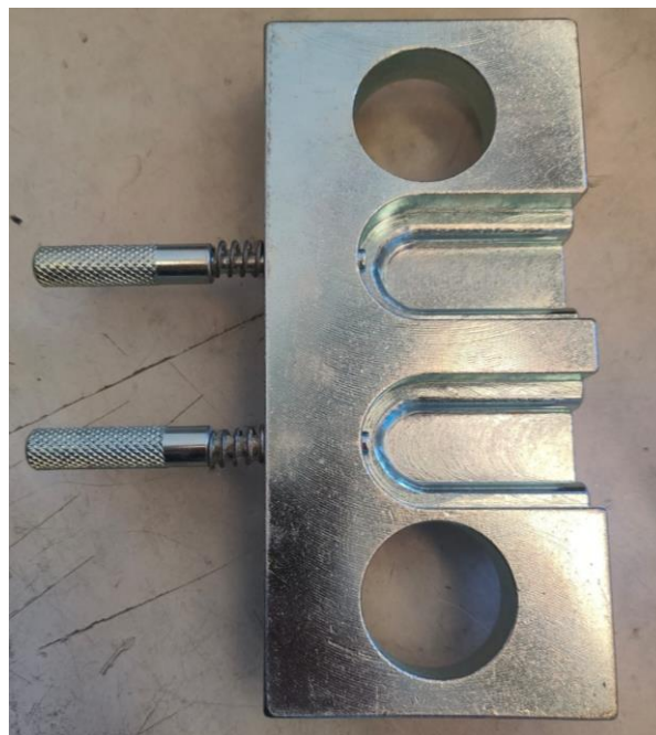
Figura 3.55 Adattatore pressa per comprimere omogeneamente il modulo e verificare la liberazione della rondella testimone
