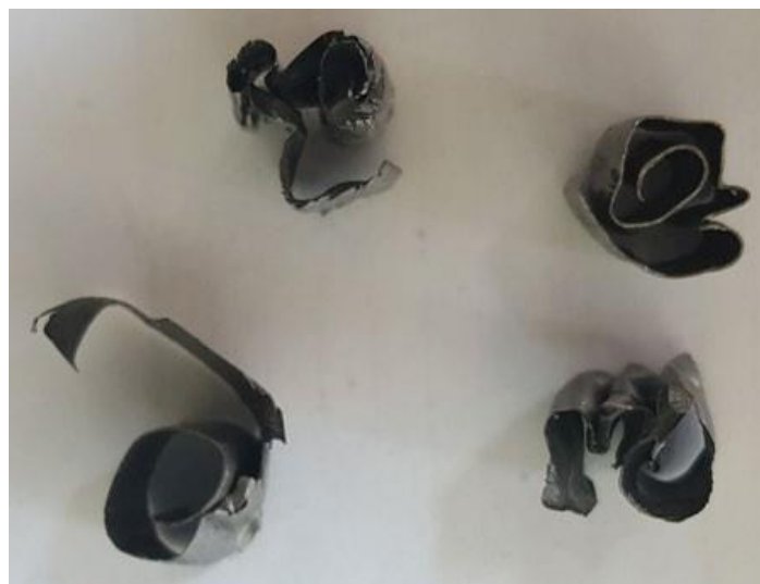
Figura 2.2.3.2 Forma non corretta del truciolo
