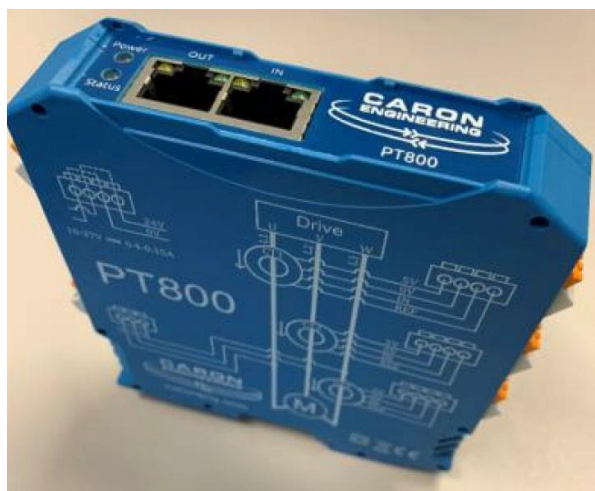
Figura 3.1.1.1 Unità centrale del sistema di misurazione della corrente
