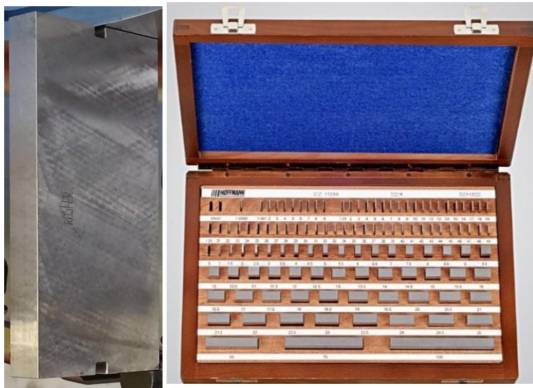
Figura 1.4.7 Spessore noto e blocchetti Johnson
