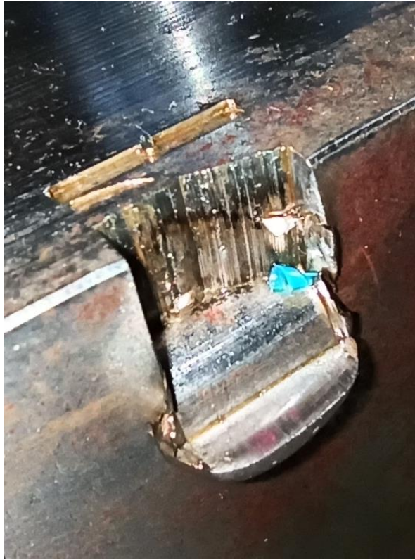
Figura 3.3.4.2 Materiale asportato a causa della rottura
