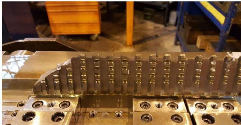
Figura 1.6.1 Rottura di una broccia a causa di progettazione errata
