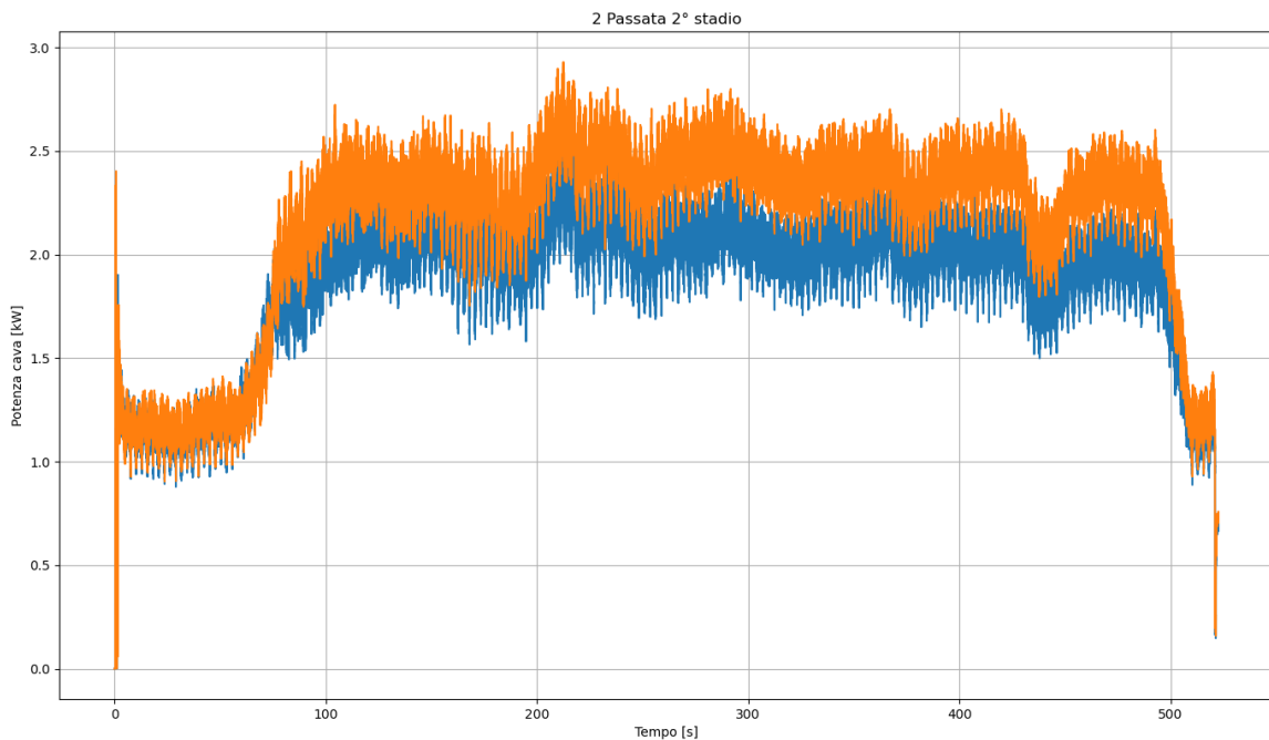
Figura 5.2.1: Grafico confronto potenza prima cava (blu) e ultima cava (arancione) della seconda passata
