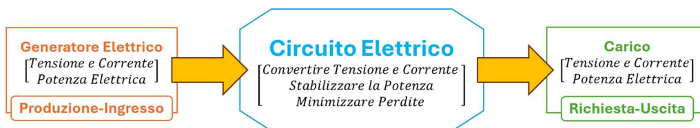
Figura 50-Caratteristiche che deve possedere il circuito elettrico
