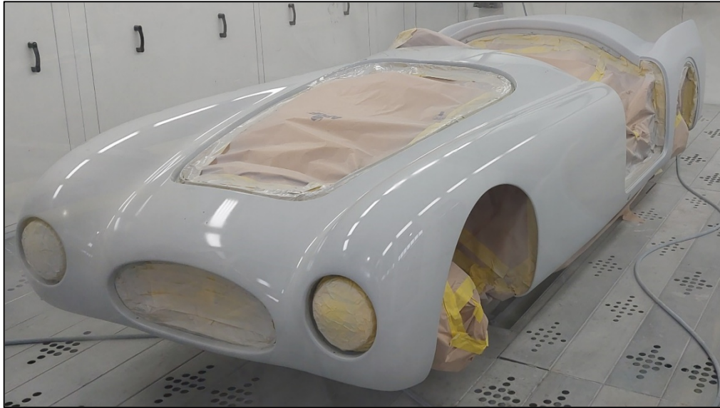
Figura 8.6. La Cisitalia 202 SMM subito dopo l'applicazione del fondo isolante.
