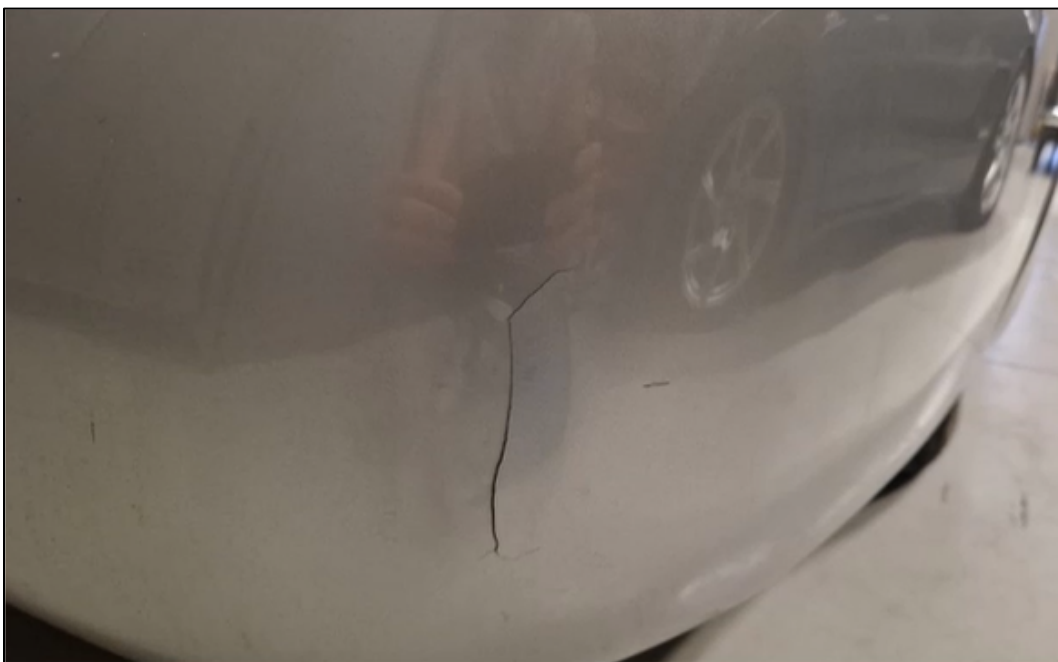
Figura 4.2. Fessurazione nella parte inferiore del parafrangente posteriore destro.
