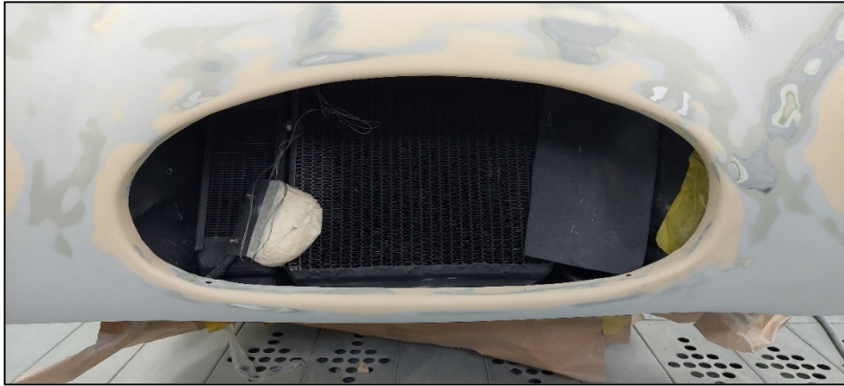
Figura 7.29. Vano mascherina radiatore in fase di modellazione con la tecnica "dell'impronta".
