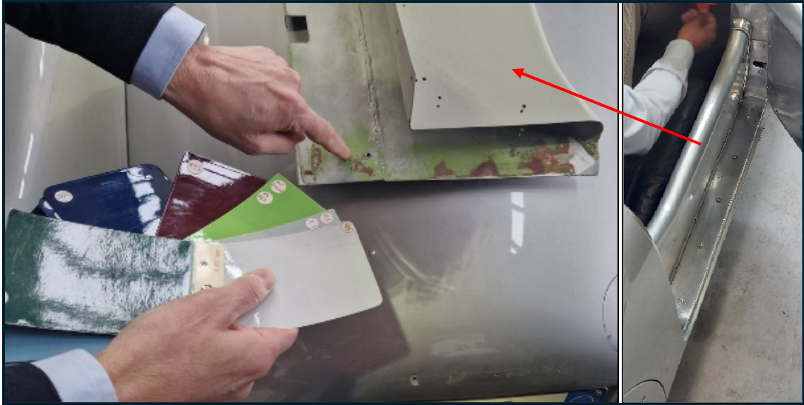
Figura 6.10. Tracce del color amaranto, che potrebbe coincidere con l' Amaranto Cisitalia 835 , sulla superficie interna dei rivestimenti in alluminio del telaio tubolare in prossimità dei vani porta (visibili a destra montati al termine del restauro). Era sempre largamente presente il fondo color verde.
