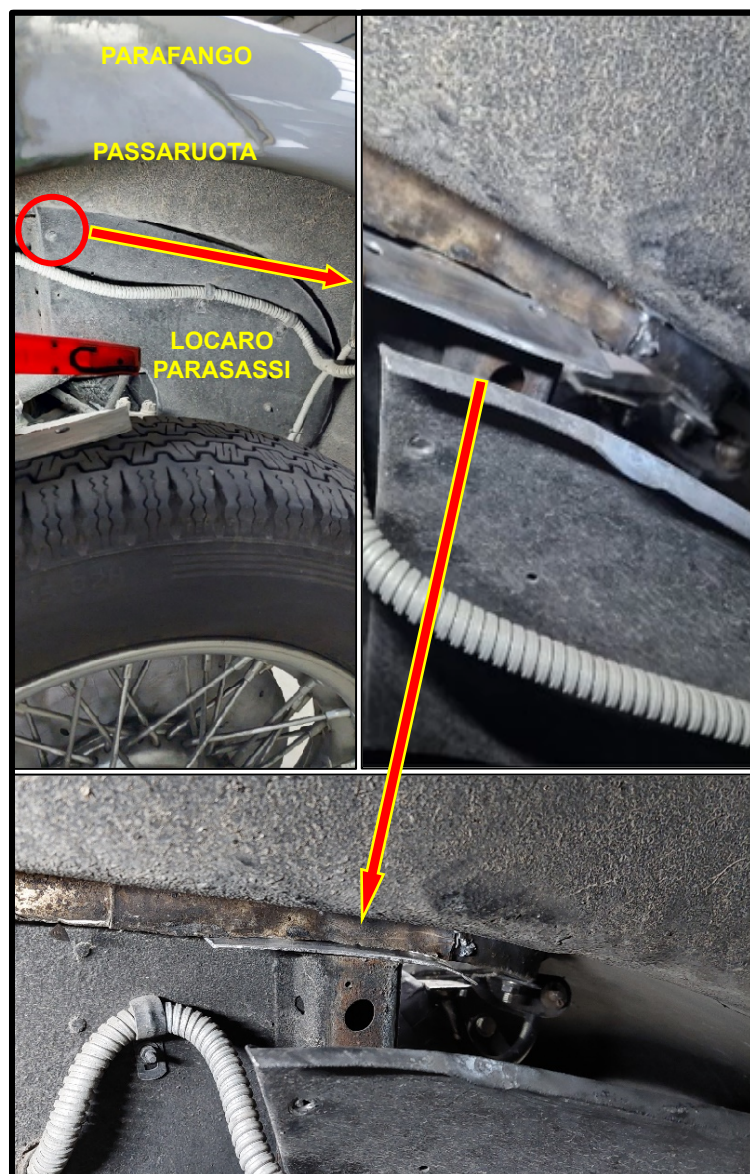
Figura 5.10. Posizionamento della piastra di rinforzo. Nella foto in alto a sinistra si può notare il parafrangente e, nella sua parte interna, il locaro parasassi avvitato.
