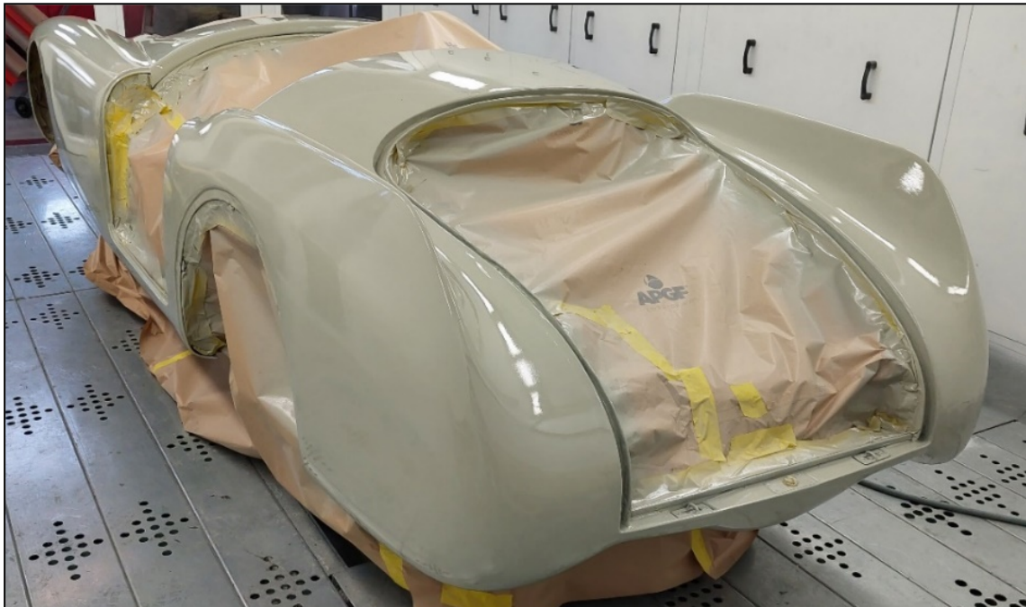
Figura 7.8. Scocca dopo il processo di applicazione del primer epossidico.
