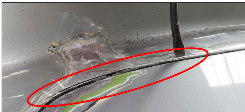
Figura 5.13. Nell'ovale rosso, taglio effettuato lungo il profilo del vano motore per procedere alla deformazione plastica del parafango anteriore destro (si intravede l'estremità del palanchino che tiene in posizione la lamiera).
