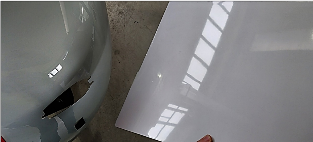
Figura 8.3. Differenza tra vernice al solvente bicomponente con lucido trasparente finale (sulla sinistra, su scocca Porsche 356) e vernice monocomponente termoplastica (sulla destra, su pannello piano). Si nota come la riflessione della vernice bicomponente sia molto più nitida.
