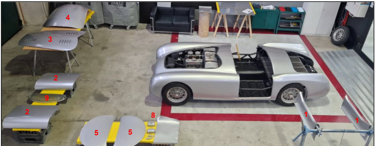
Figura 9.4. La Cisitalia predisposta per il montaggio dei componenti (numerati secondo l'elenco a pagina seguente).
