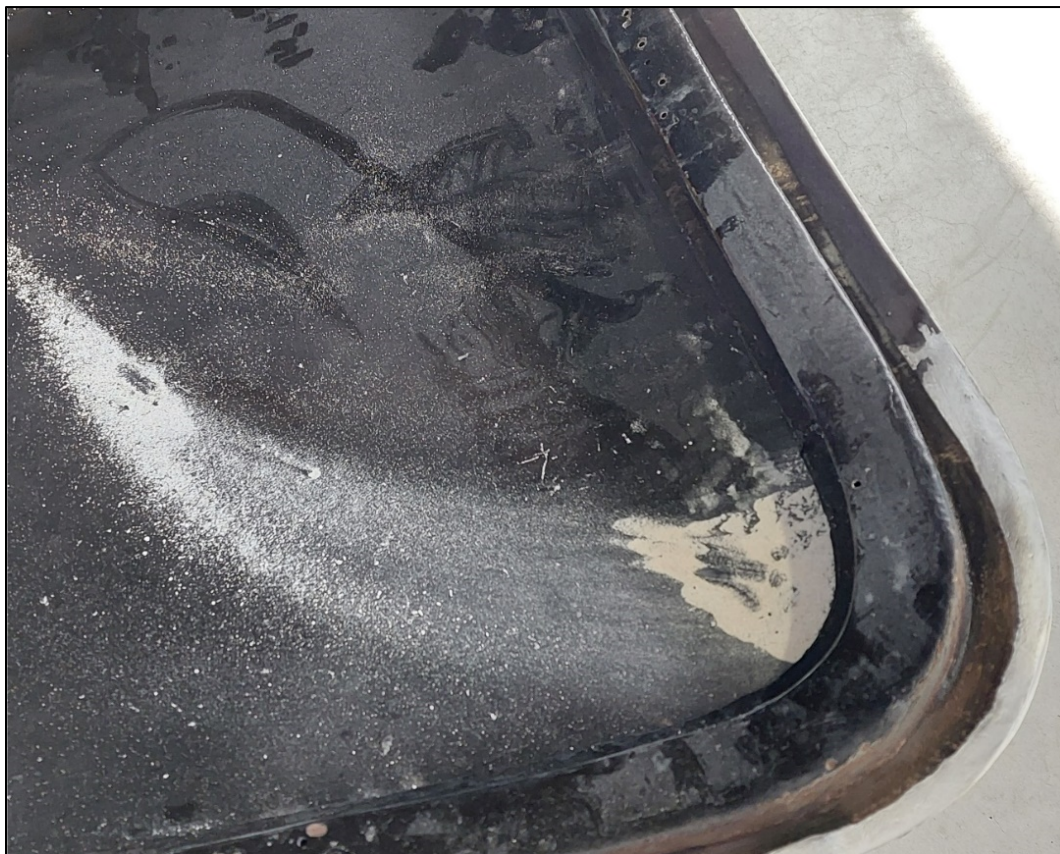
Figura 5.17. Polvere di ossido d'alluminio (allumina) che si è presentata durante la pulitura del profilo perimetrale del cofano posteriore.
