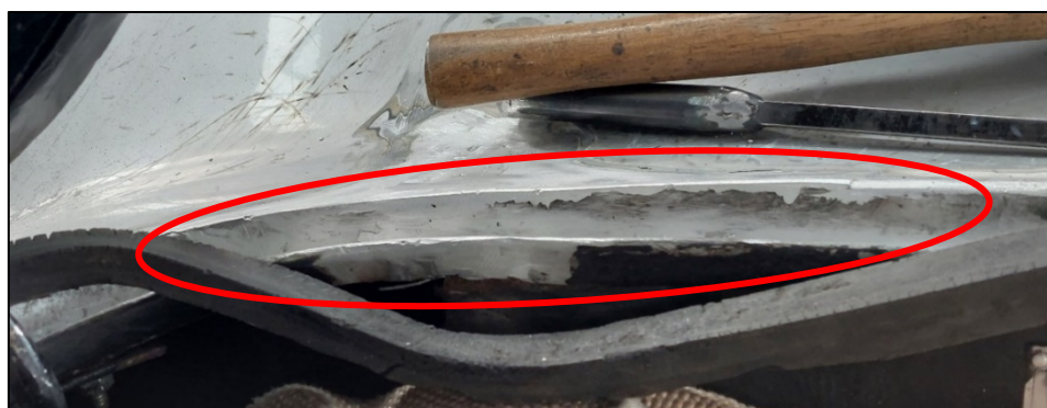
Figura 5.14. Evidenziato in rosso, profilo dopo saldatura e smerigliatura. In primo piano la vecchia guarnizione del vano motore. Sopra le impugnature di martello e palanchino.
