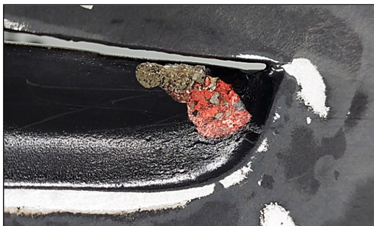
Figura 6.17. Tracce di Rosso Corsa all'interno delle feritoie del cofano anteriore.
