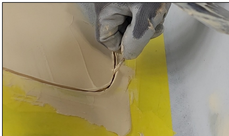
Figura 7.18. Asportazione dello stucco morbido in eccesso tramite punta da trapano di 3 mm (accoppiamento cofano posteriore – parafango).
