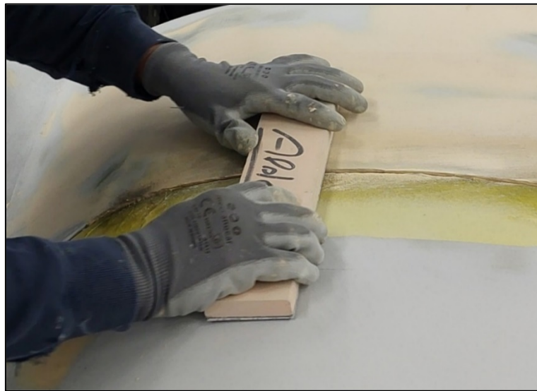
Figura 7.21. Levigatura tramite tampone e carta abrasiva (accoppiamento cofano posteriore – profilo vano portabagagli).
