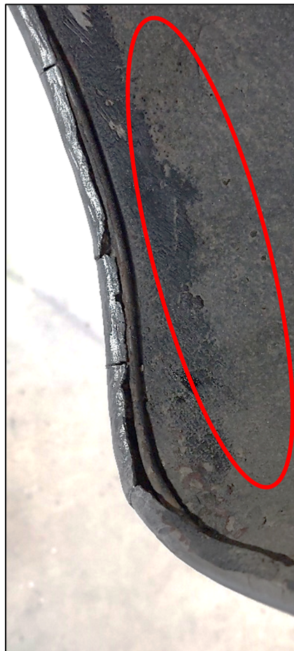
Figura 5.16. Passaruota del parafango anteriore sinistro: notare l'anima in acciaio a sezione circolare e l'alluminio ripiegato su di essa, che risulta corrosivo (anche questo particolare è stato ripristinato tramite saldatura MIG). La zona nera in figura (cerchiata in rosso) è sempre l'alluminio della scocca rivestito in materiale antirombo che va a costituire una parte del locaro parasassi.
