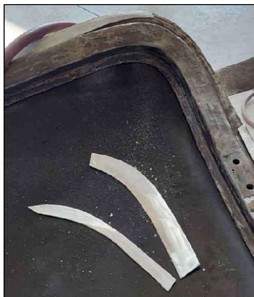
Figura 5.19. Tagli e modellazione tramite smerigliatrice di due componenti nuovi da saldare lungo il bordo del cofano posteriore.
