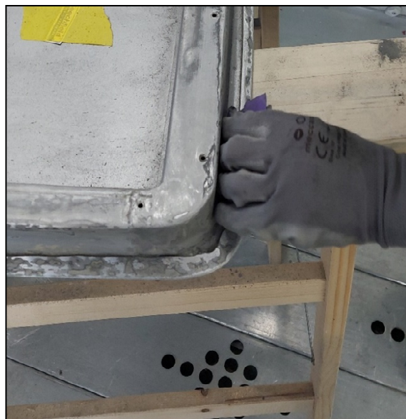
Figura 7.5. Carteggiatura manuale senza l'ausilio di tampone lungo i profili di una delle due porte. Osservare la presenza delle griglie di aspirazione della cabina di verniciatura.
