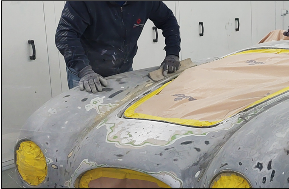
Figura 7.4. Esempio di carteggiatura di profilo negativo (cioè con concavità rivolta verso l'alto) eseguita tramite tampone artigianale.
