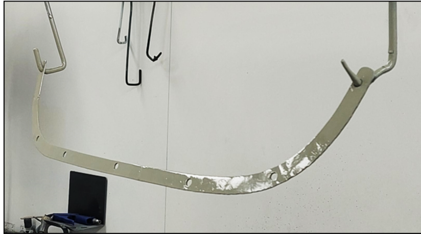
Figura 7.9. Il primer aggrappante epossidico steso sopra la piastra di rinforzo in acciaio delle cerniere del cofano anteriore. Essa presentava evidenti segni di corrosione.
