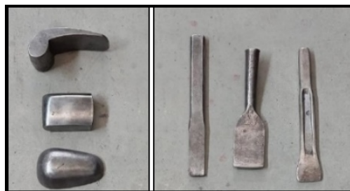
Figura 5.2. Panoramica su alcuni tasselli metallici (a sinistra). A destra scalpelli / leve. L'utilizzo di ogni strumento è connesso strettamente all'esperienza di ogni singolo professionista, che può usare tecniche diverse per arrivare alla stessa forma della lamiera desiderata.
