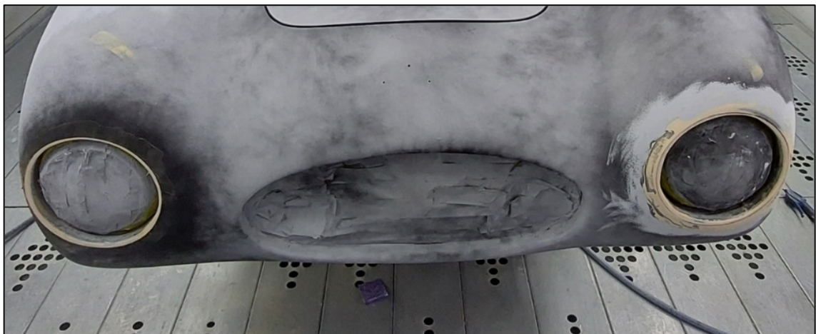
Figura 7.28. Differenza tra profilo griglia faro che ha ricevuto il nero spia e deve essere ancora carteggiato (in foto sulla sinistra) e profilo invece che è già stato modellato e carteggiato (in foto sulla destra).
