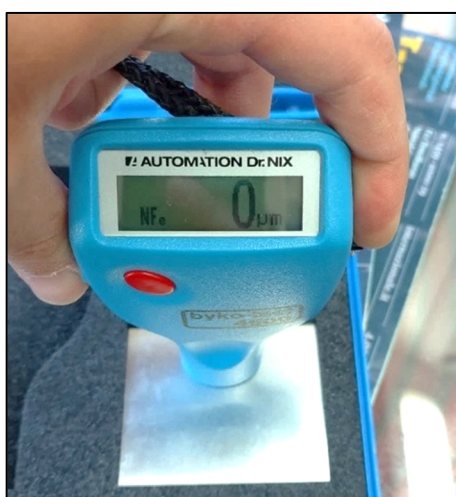
Figura 6.2. Regolazione dello zero del byko-test 4500 . Notare che si è nella modalità di misura NFe , necessaria per condurre analisi su substrati in alluminio. I valori rilevati vengono espressi in micrometri o automaticamente in millimetri in base allo spessore del rivestimento rilevato.
