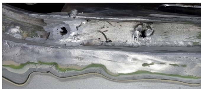
Figura 5.12. Altri due fori sulla parte sinistra del profilo vano motore che hanno ricevuto saldatura e attendono di ricevere foratura tramite trapano (punta con diametro 8 mm): quello a sinistra è stato già smerigliato, quello a destra non ancora.
