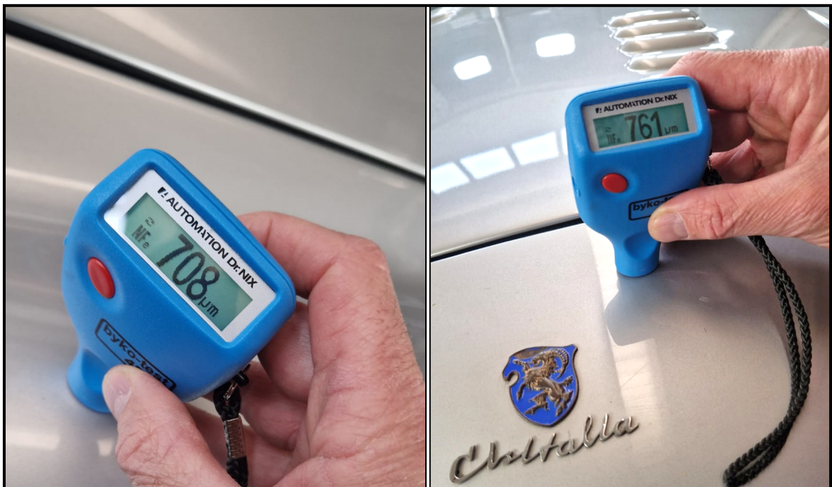
Figura 4.8. Esempi delle misurazioni degli spessori dei vari strati di rivestimenti dell'alluminio della carrozzeria (in particolare, in prossimità del perimetro del cofano motore).
