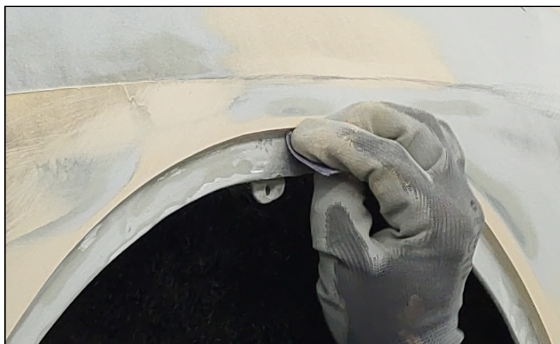
Figure 7.20. Levigatura dello stucco sull'arcata del parafrangente posteriore destro senza adoperare la spatola metallica.
