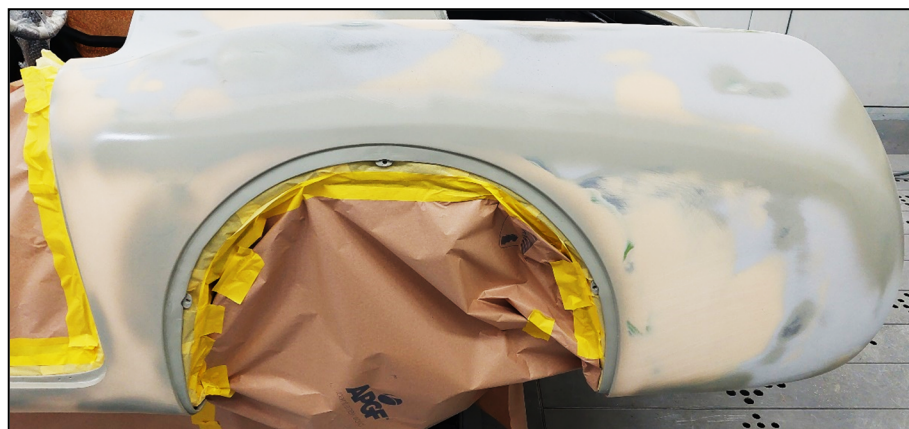
Figura 7.13. Particolare del parafrangente posteriore sinistro: si possono riconoscere le zone sulle quali è stato riapplicato il primer epossidico (contraddistinte da un grigio tendente al verde), il fondo in poliuretano (color grigio chiaro) e lo stucco usato in modellazione (color beige).
