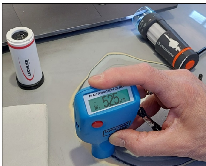
Figura 6.1. Sulla sinistra, lo strumento color bianco è il misuratore di colore; in mano vi è lo spessimetro, in alto a destra si può osservare il microscopio digitale (collegato tramite USB a un computer per visualizzare l'immagine).
