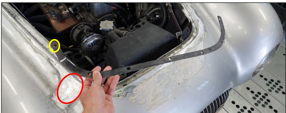
Figura 5.4. Piastra superiore di rinforzo per l'attacco delle cerniere anteriori del cofano motore. Nel cerchio rosso la zona di propagazione della cricca (qui già ripristinata). Nel cerchio giallo il foro coincidente con il punto di serraggio della piastra dal quale si è propagata la cricca. Sullo sfondo la gola di alloggiamento della guarnizione del vano motore e della piastra in questione.
