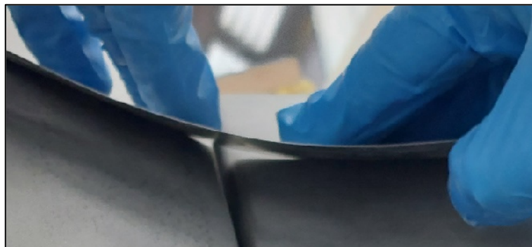
Figura 7.23. Verifica del profilo del raccordo tra cofano posteriore e parafrangente posteriore. Al centro si evidenzia un'imperfezione di raccordo.
