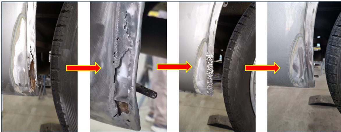
Figura 5.15. Riparazione del danno dovuto a corrosione perforante della lega d'alluminio sulla zona inferiore del passaruota del parafrangente posteriore destro.
