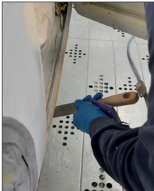
Figura 7.30. Esempio rimozione stucco tramite martello e scalpello.
