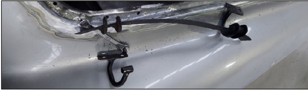
Figura 5.5. Piastra inferiore di alloggiamento delle cerniere, posizionata in prossimità del radiatore nella parte interna del vano motore, ancorata alla scocca in alluminio. Le cerniere montate sono ben visibili in Figura 5.3 .
