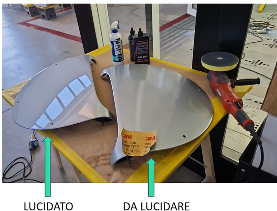
Figura 9.1. Coperchi di copertura delle ruote posteriori notare la differenza tra componente lucidato e non ancora lucidato.
