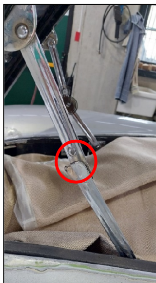
Figura 5.6. Cerniere in acciaio cromato, serrate lungo i profili laterali del vano motore e del telaio portante della struttura del cofano. Nel cerchio rosso, il fincorsa ricostruito tramite saldatura MAG per acciaio (smerigliando ed eliminando prima la cromatura).
