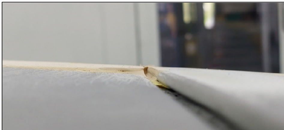
Figura 7.22. Dettaglio della deposizione di stucco (nella foto già levigato) sopra la scocca per portarla in piano con il cofano anteriore (a destra), che nella foto risulta più sopraelevato.
