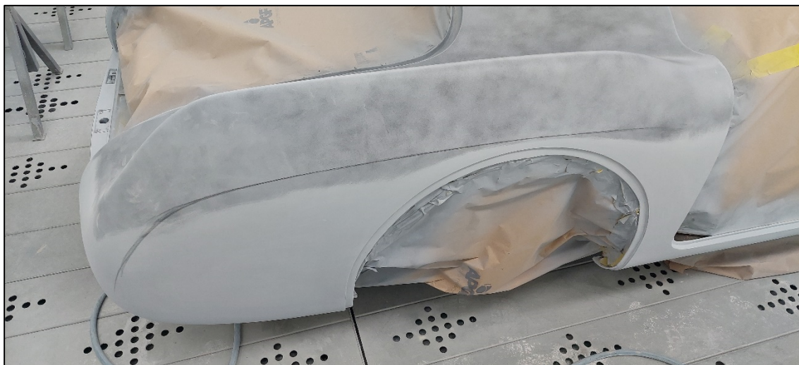
Figura 7.32. Netta differenza tra zona carteggiata (parte chiara) e quella ancora da levigare (dove è presente il nero spia ).
