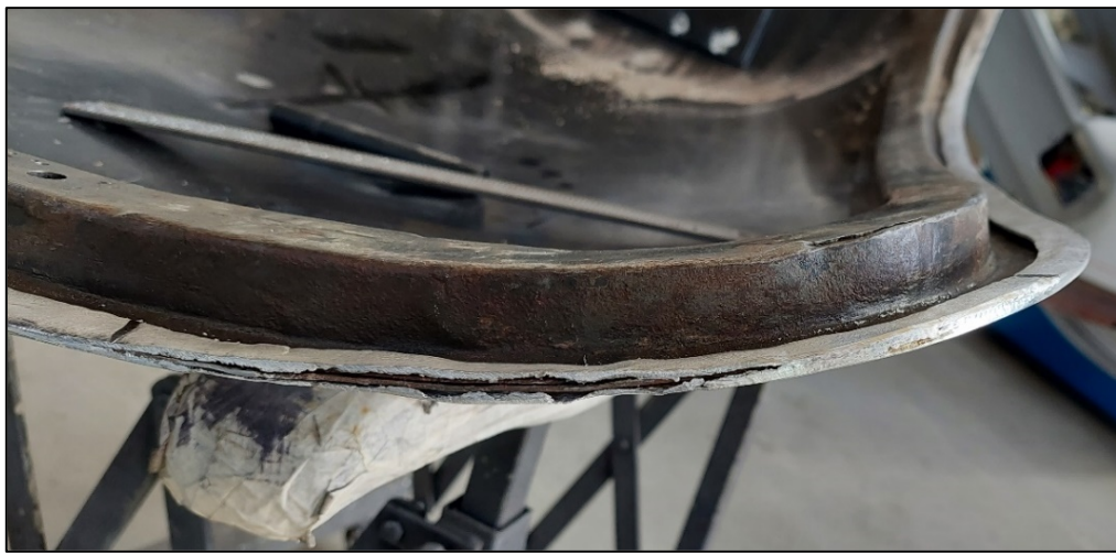
Figura 5.18. Profilo perimetrale del cofano posteriore fortemente degradato dalla corrosione dell'alluminio.
