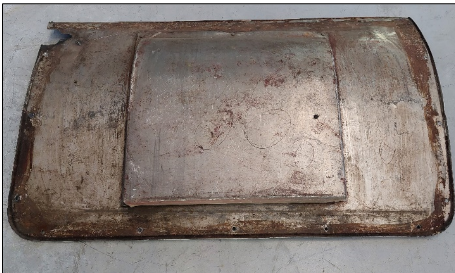
Figura 6.13. Faccia posteriore del pannello interno dello sportello destro: si può notare la struttura della tasca.
