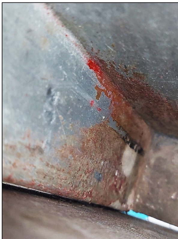
Figura 6.16. Tracce di Rosso Corsa dentro la tasca del pannello interno in alluminio dello sportello destro.
