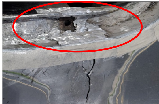
Figura 5.8. Saldatura lungo i fianchi del profilo della gola della guarnizione del vano motore.
