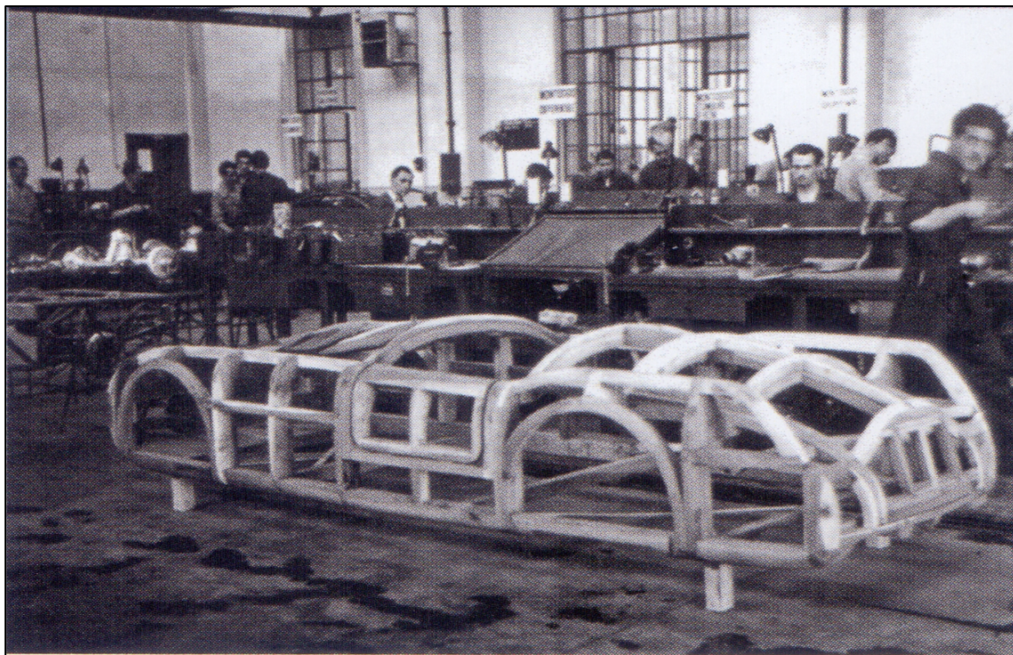
Figura 3.5. Mascherone in legno utilizzato per fissare le linee della Cisitalia 202 SMM [4] .
