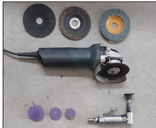
Figura 5.1. A partire da sopra: smerigliatrice angolare con alcune varianti di dischi (per l'uso specifico, fare affidamento ai produttori). Sotto, smerigliatrice pneumatica con dischetti abrasivi.
