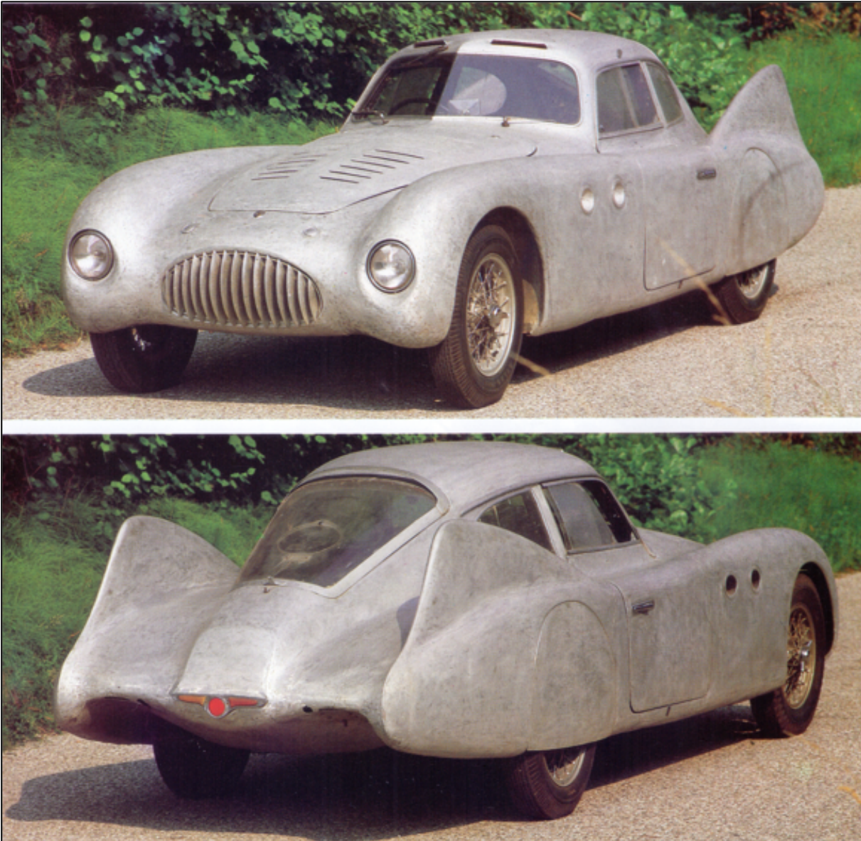
Figura 3.3. Due viste 3/4 ritraenti la Berlinetta Aerodinamica , anche denominata Cisitalia 202 CMM (Coupé Mille Miglia) . Si possono notare alcune delle soluzioni aerodinamiche adottate, come le grandi pinne posteriori con funzione stabilizzatrice ad alte velocità, il muso basso con effetto deportante, le carenature delle ruote posteriori, gli estrattori posteriori [4] [5] .
