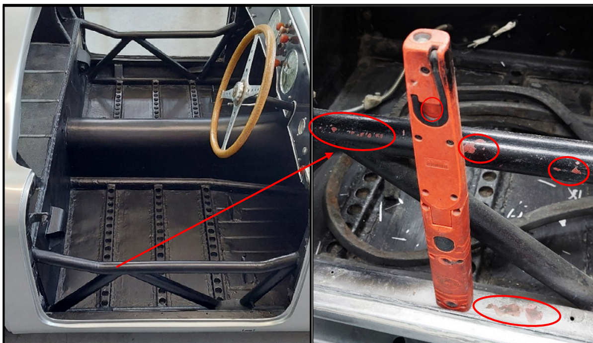
Figura 6.9. A destra, tracce del prodotto color amaranto sotto la vernice nera (cerchiate in rosso). Entrambi rivestivano il telaio tubolare in acciaio al cromo – molibdeno (a sinistra raffigurato dopo la verniciatura). La lampada portatile arancione in figura è stata molto utile durante le analisi, perché dotata di calamita all'estremità: si sono riconosciute più velocemente le zone in acciaio rispetto a quelle in alluminio.
