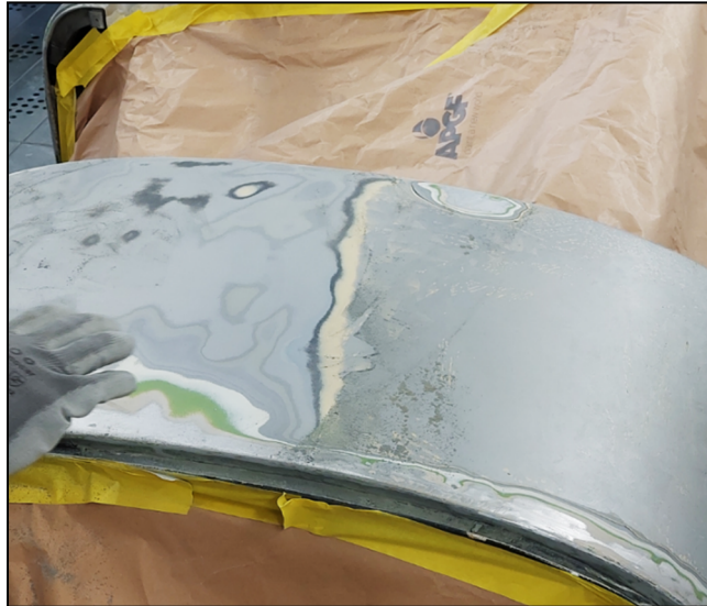
Figura 7.7. Differenza tra superficie carteggiata (sulla sinistra) e ancora da carteggiare (sulla destra).
