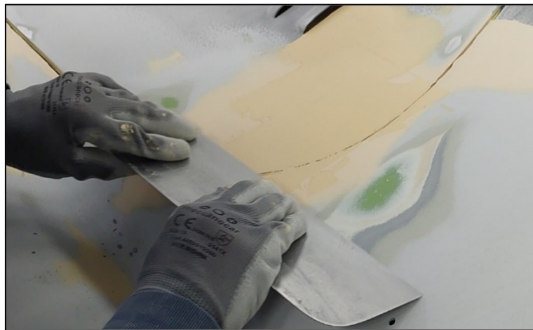
Figura 7.17. Deposizione dello stucco tramite spatola metallica (accoppiamento cofano anteriore – profilo vano motore).
