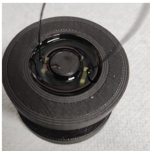
**Figura 3.9:** PDMS colato all'interno del mold.
