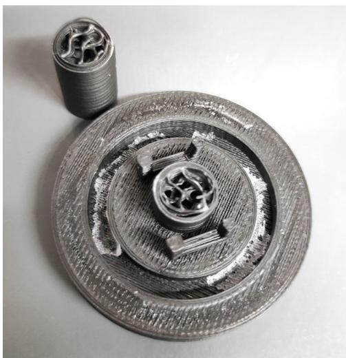
**Figura 3.6:** Mold rotto a causa della bassa densità di riempimento.
