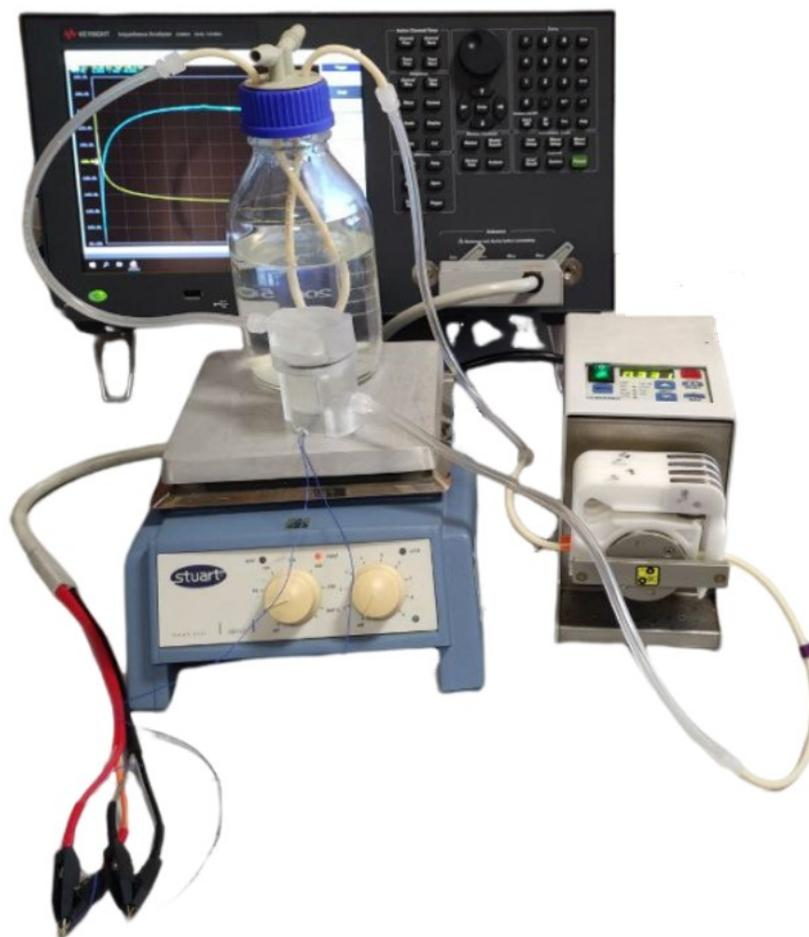
**Figura 2.3:** Banco di prova del set-up di perfusione.
