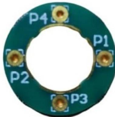
**Figura 2.19:** Top view della PCB circolare con quattro elettrodi d'oro.
