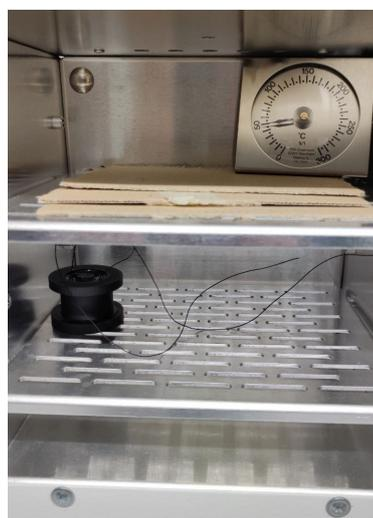
**Figura 3.10:** Mold completo con gli elettrodi a piastre in forno.
