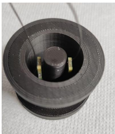
**Figura 3.7:** Mold completo con gli elettrodi a piastre inseriti.
