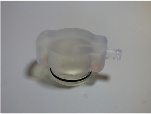
**Figura 2.13:** Pezzo inferiore del bioreattore modificato
