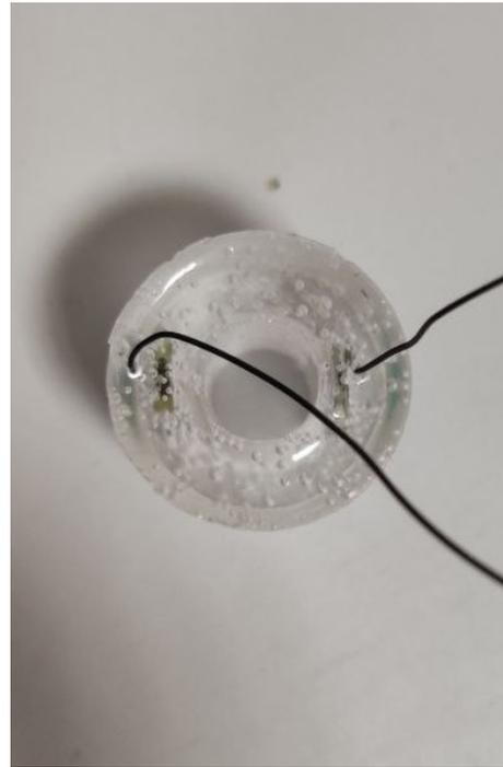
**Figura 3.13:** Visione dall'alto dell'holder con gli elettrodi a piastre.
