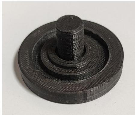
**Figura 2.7:** Mold inferiore per elettrodi circolari.
