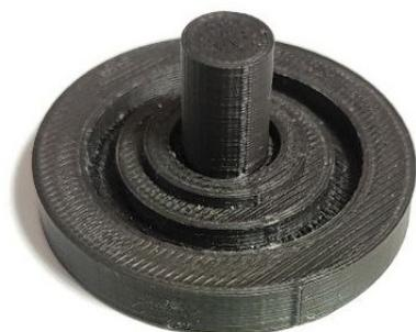
**Figura 3.16:** Mold per la costruzione dell'holder con elettrodi circolari.
