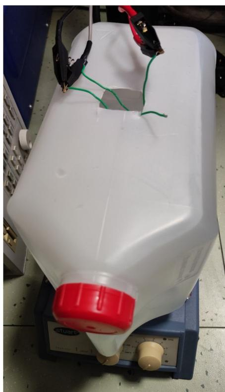
**Figura 3.23:** Setup per le misurazioni con acqua di rubinetto in condizioni statiche.
