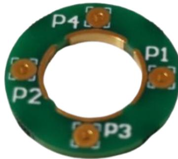
**Figura 2.18:** PCB circolare con quattro elettrodi d'oro.
